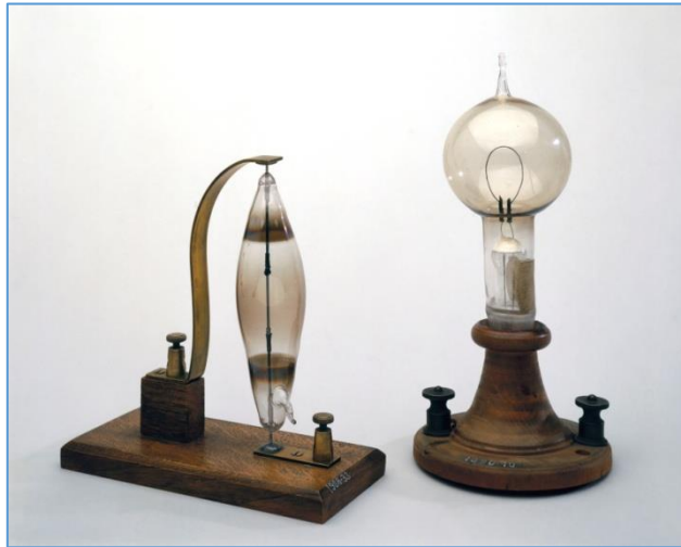
Figura 3.6. Primeras bombillas de Swan (izquierda) y Edison (derecha). Fuente: Science Museum Londres, imagen 10276216
