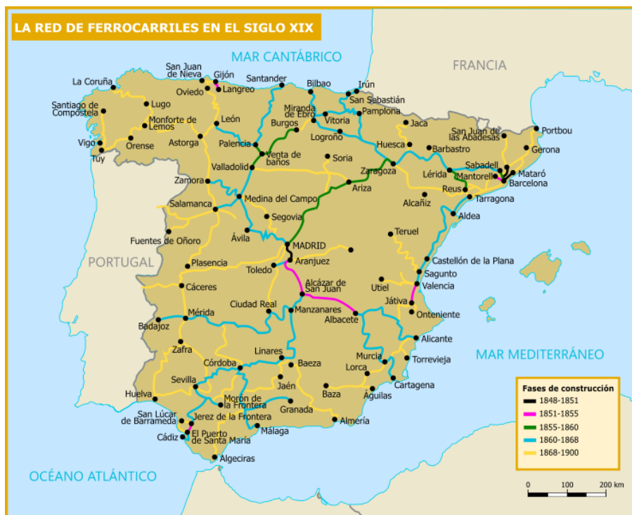
Figura 2.3. Mapa ferroviario español de final de siglo XIX. Fuente: Wikipedia. Licencia CC. Obtenida de https://commons.wikimedia.org/wiki/File:La_red_de_ferrocarriles.svg#metad_ata
