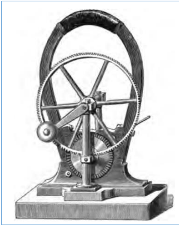
Figura 4.1. Dinamo de Gramme de laboratorio con imán laminado o de Jamin. Fuente: La physique moderne . Hospitalier (1882).
