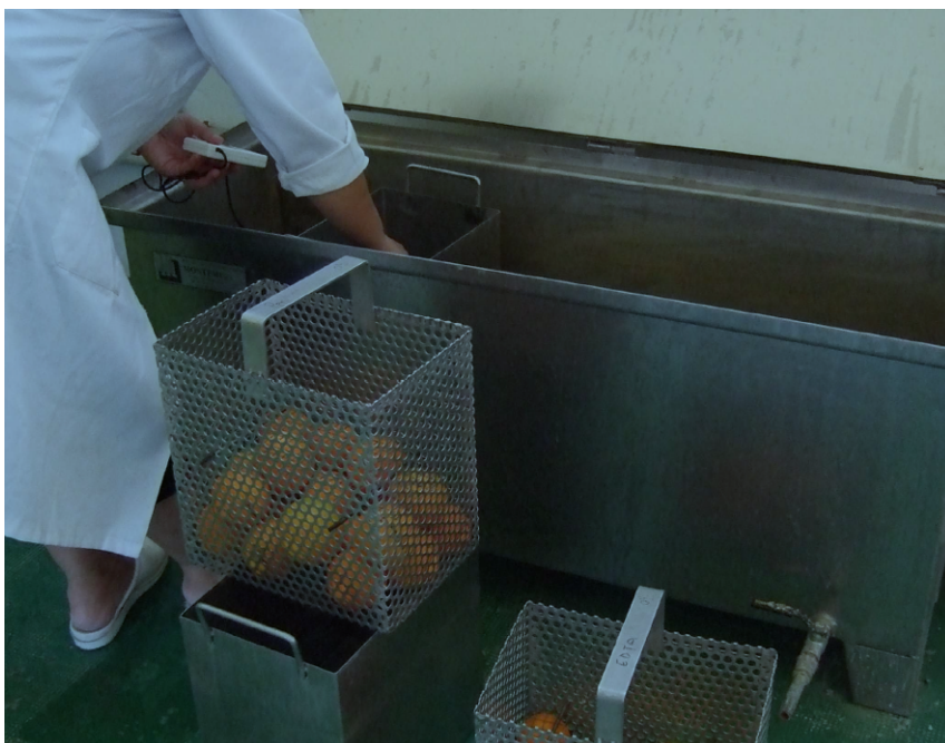
Figura 4.6: Comprobación de la temperatura de agua caliente en la balsa de tratamiento mediante un termómetro digital con sonda metálica inoxidable tipo pt100 y los cestos utilizados para colocar los frutos.
