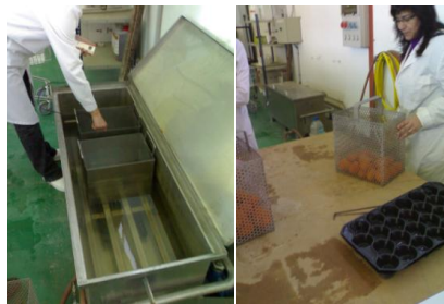
Fig. 4. Balsa y cestas para tratamiento con agua caliente
