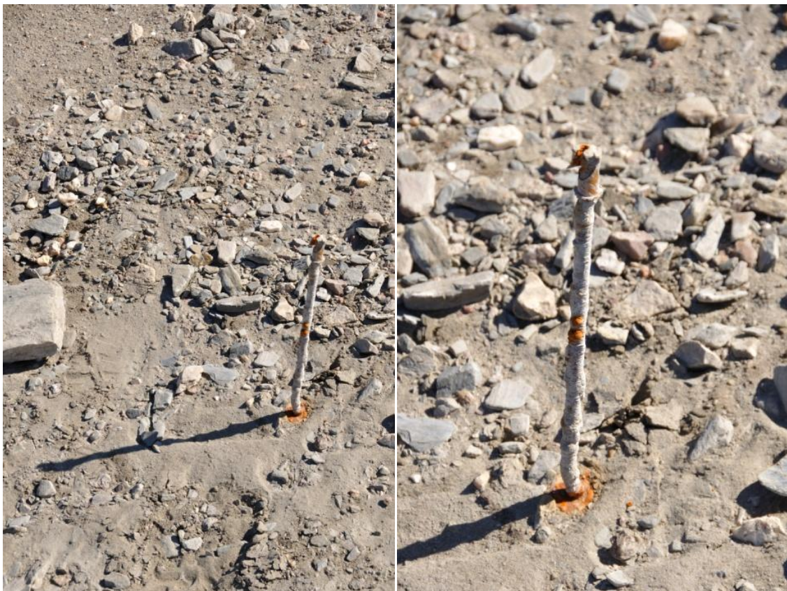
Fig. 40: Sistema de control de sedimentación y erosión, la varilla es el testigo y la arandela representa la superficie original
