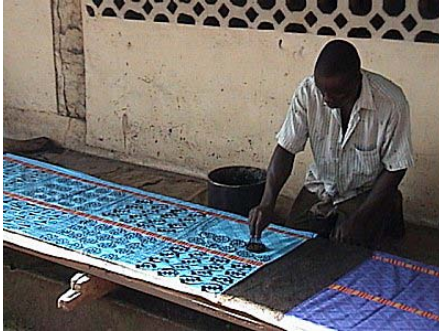
▲ Figs. 138 y 139. Estampador ghanés aplicando la técnica con matriz de calabaza y pigmento directo sobre tela de algodón. Vista lateral de una matriz de calabaza con cuatro piezas de madera para formar el mango.
