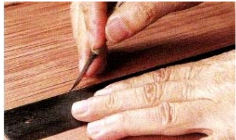
► Fig. 170. Un artesano realizando finas líneas de corte para el diseño de una plantilla plantilla katagami con cuchilla shimabori.
