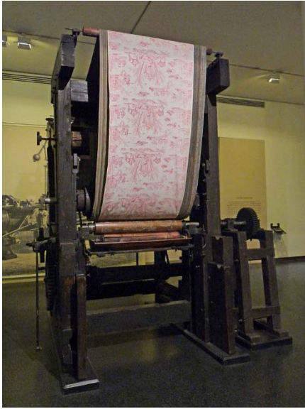
▲ Fig. 93. Prensa con rodillos de cobre con ejemplo de tela estampada. Musée L'impression sur étoffes. Mulhouse.
