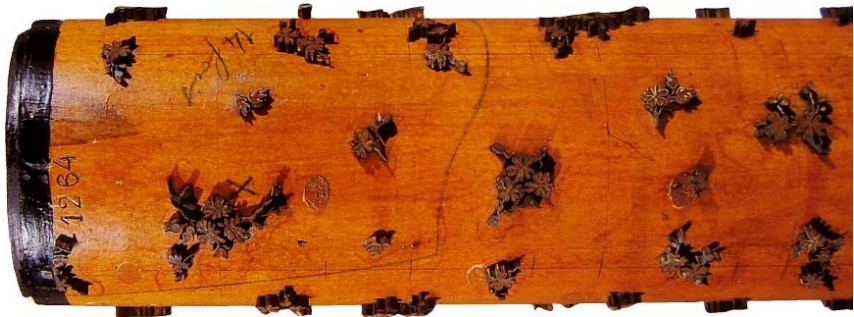
▲ Fig. 95. Rodillo de madera con perfiles metálicos para estampación de tejidos
