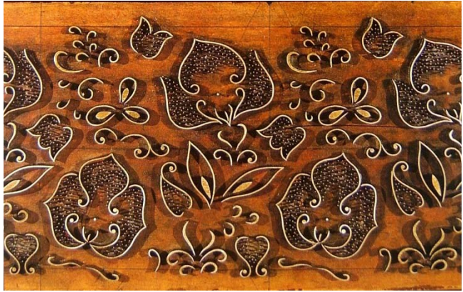
► Fig. 44. Detalle de matriz para color rojo perrotina con perfiles metálicos.
