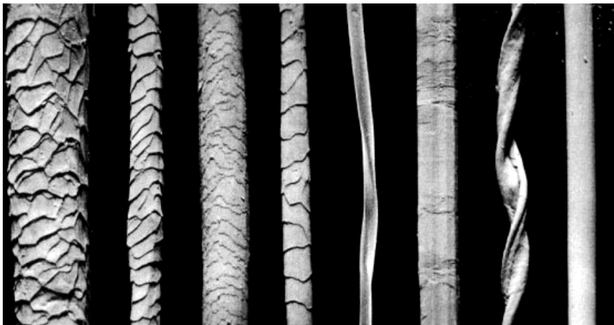
▲ Figs. 227. Diferentes fibras bajo microscopio electrónico. De izq. a dcha: fibra de lana corse , lana fina, lana de alpaca, lana cachemira, seda, lino, algodón y poliéster.
