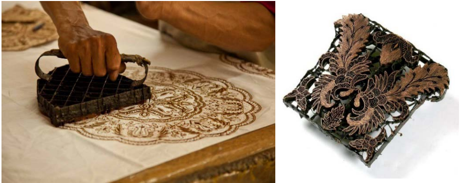
▲ Figs. 133. Izq.: un estampador aplica con un tjap la cera caliente sobre la tela de algodón. Se aprecia la forma redondeada de un extremo de la matriz que contiene parte de la figura total del diseño, que es realizado por el case de cuatro impresiones. ▲ Derecha: otra matriz tjap con partes del diseño de hojas sobresalientes del bloque.
