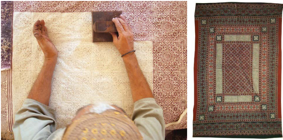
▲ Fig. 119 y 120. Detalle de un impresor sindhi aplicando un bloque de madera con tinte sobre una tela de algodón tratada anteriormente. ▲ Ejemplo de estampación de una tela ajrakh.
