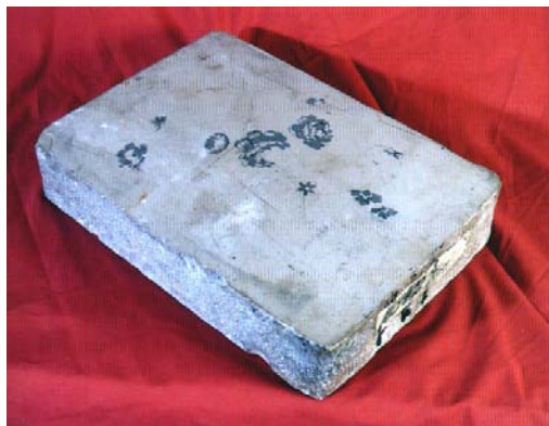
▲ Fig. 101. Piedra litográfica empleada para estampación de textiles.
