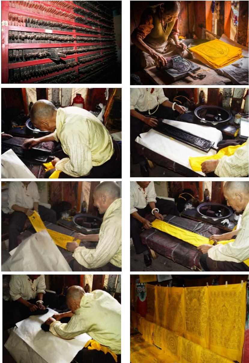
▲ Figs. 129. Proceso de estampado sobre tela en Dé gé yìn bǎn huà fāng (Casa del grabado en madera Derge). En las siguientes imágenes, se observan estanterías con alargadas matrices de madera, maestro entintando una matriz de Buda, maestro y ayudante imprimiendo un texto-imagen sobre tela, y sección de secado de las impresiones sobre algodón amarillo.
