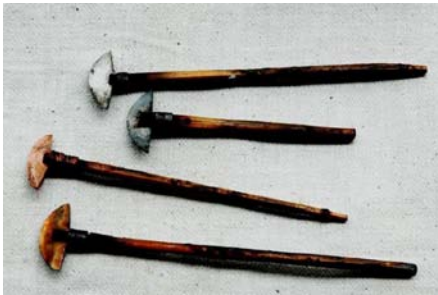
▲ Fig. 201. Utensilios para la aplicación en el batik chino, llamados lādāo o huàdāo .
