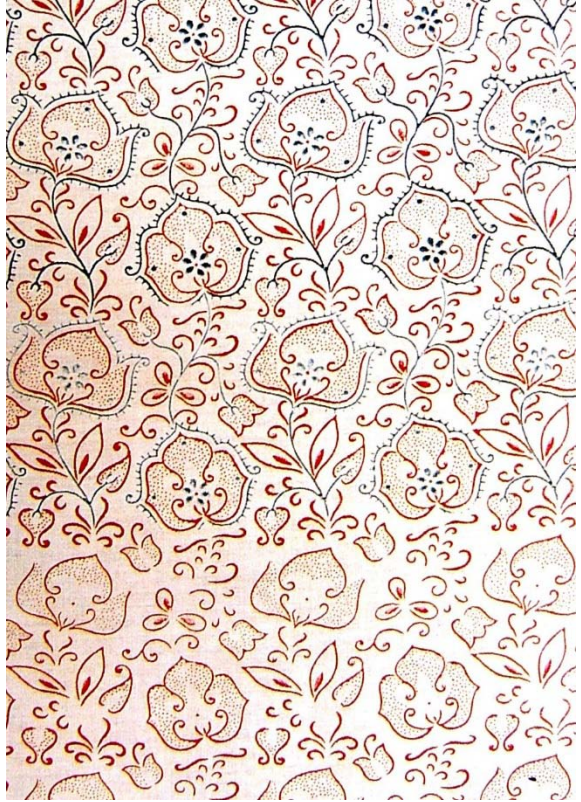
► Fig. 46. Tela estampada con sistema perrotina. Detalle del primer color en rojo y el segundo en azul. La parte inferior carece de la estampación azul.
