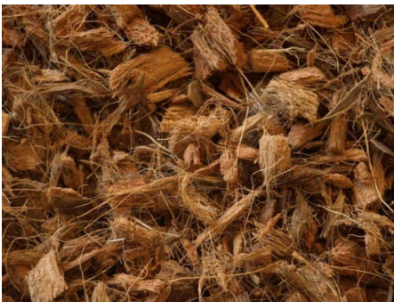
▲ Figs. 232. Bonote de fibra marrón, de cocos maduros, y bonote de fibra blanca, más fina, extraída de los cocos verdes, que son sometidos a varios procesos para ablandar la fibra.
