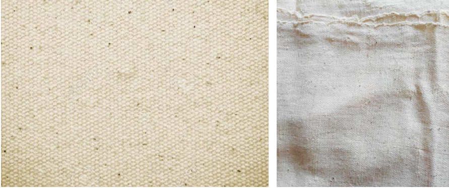
▲ Figs. 229. Distintos tipos de telas de algodón crudo, en ligamento sarga y tafetán respectivamente.
