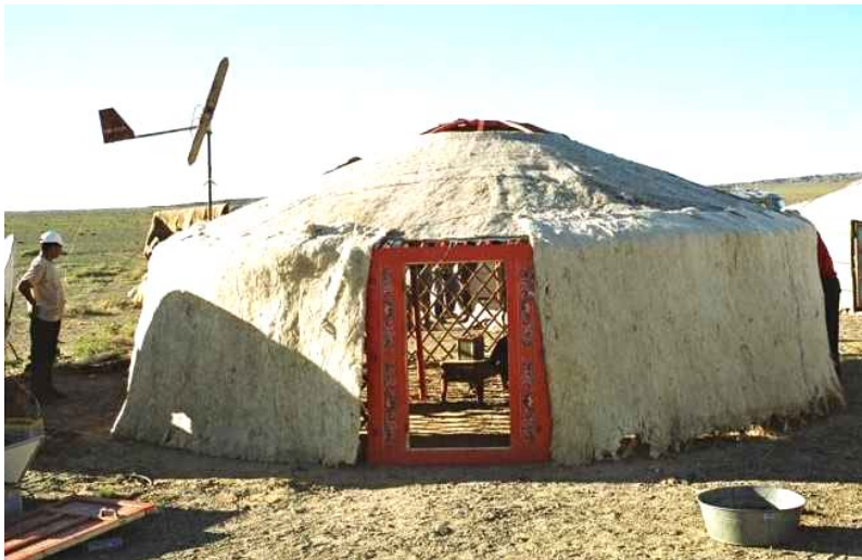
▲ Figs. 262. Ger mongol. Estructura de madera y cubierta de fieltro.
