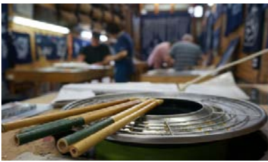
◀ Fig. 216. Recipiente que mantiene líquida la cera, por efecto de calor eléctrico.
