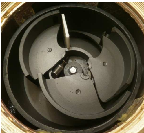
FIGURA 3.22 ROTURA DEL PISTÓN EN CONTADORES VOLUMÉTRICOS
