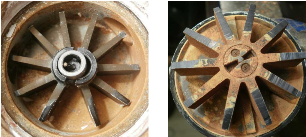
FIGURA 3.23 ROTURA Y DETERIORO DE TURBINAS EN CONTADORES DE VELOCIDAD
