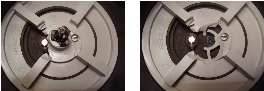
FIGURA 3.19 SOPORTE DE EJE DETERIORADO DEL CONTADOR CORRESPONDIENTE AL REGISTRO 95
