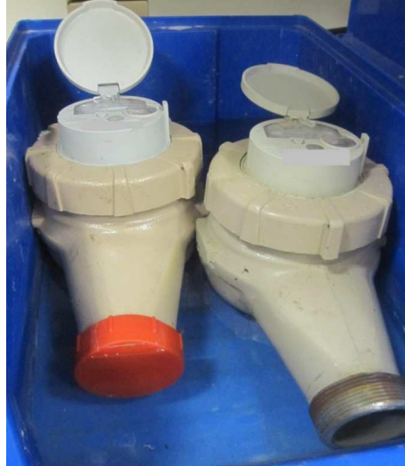
FIGURA 3.13 CONTADORES ALMACENADOS EN CONDICIONES DE HUMEDAD ADECUADAS PARA SU POSTERIOR ENSAYO
