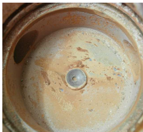
FIGURA 3.21 DESGASTE Y ROTURA DEL EJE DE LA TURBINA DE UN CONTADOR DE VELOCIDAD
