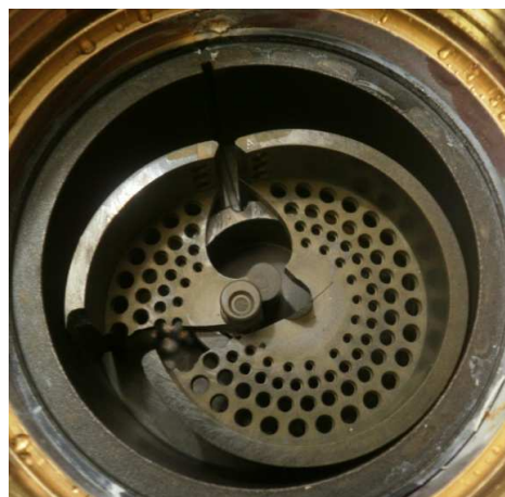
FIGURA 3.22 ROTURA DEL PISTÓN EN CONTADORES VOLUMÉTRICOS
