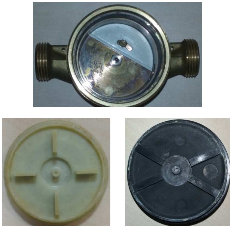
FIGURA 4.4 DIFERENTES MÉTODOS DE AJUSTE DEL CAUDAL PARA UN CONTADOR
