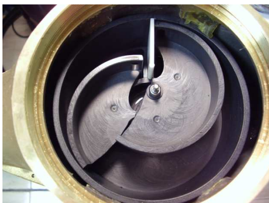
FIGURA 3.11 ROTURA DE CONTADOR VOLUMÉTRICO POR CAUDALES ELEVADOS
