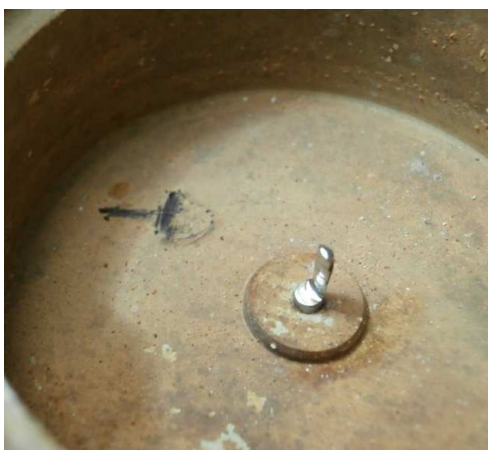
FIGURA 3.21 DESGASTE Y ROTURA DEL EJE DE LA TURBINA DE UN CONTADOR DE VELOCIDAD
