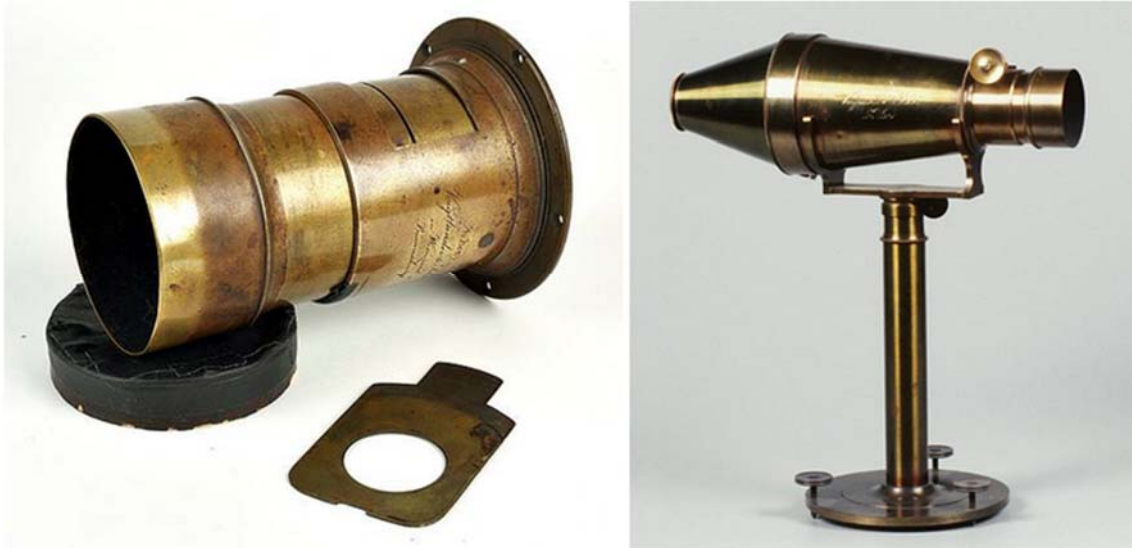
# 16 Lentes Petzval (izq.) y cámara Voigtländer con lentes Petzval, 1841 (dcha.).
