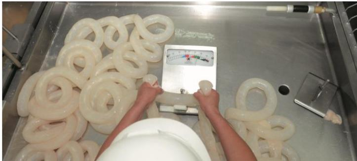
**Figura V.19.** Detalle del proceso de calibrado de la tripa desarrada.
