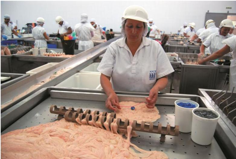
**Figura V.20.** Detalle del proceso de identificación de las madejas, una vez calibradas y armadas según las exigencias del cliente. En la figura pueden observarse, en segundo plano en las mesas, los hilos de colores. En primer plano, se utiliza un hilo rojo.
