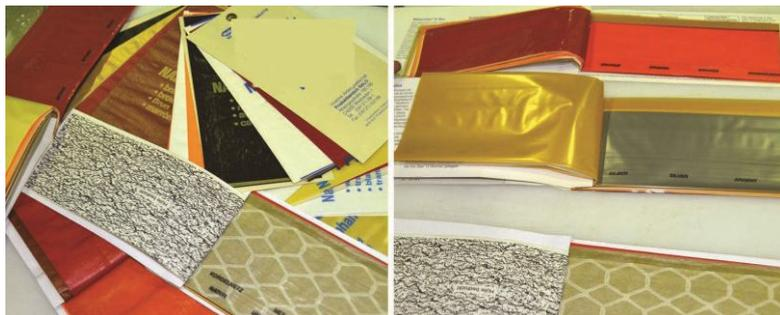
**Figura I.1.** Diferentes tipos de tripas: poliamida, celulosa y colágeno.
