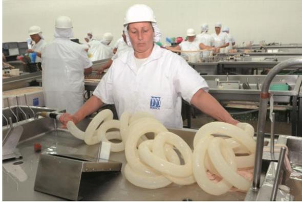
**Figura V.18.** Detalle del proceso de calibrado de la tripa desarrada insuflando aire comprimido en su interior y comparando con una escala ubicada en la mesa.
