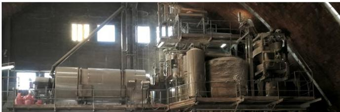
**Figura V.13.** Línea de purificación y secado de sal.
