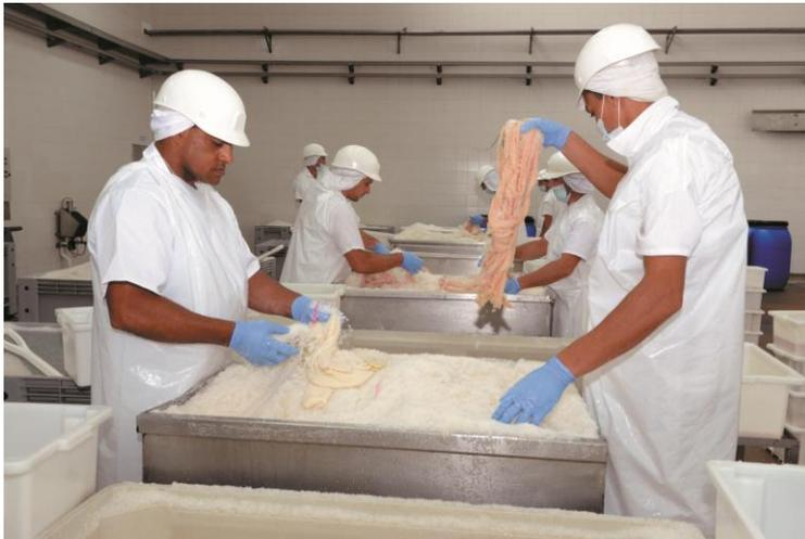
**Figura V.21.** Proceso de salado a mano de las madejas luego de la calibración.
