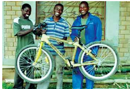
Fig. 29: Cuadro de la bicicleta construido con bambú. Fuente: Bicicletas de Bambú http://www.enlomio.com
