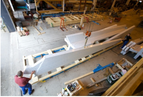
Fig. 188: Fabricación de las diferentes piezas de cada árbol. Para su traslado son protegidas con una cubierta de plástico. Fuente: Patrick Wack
