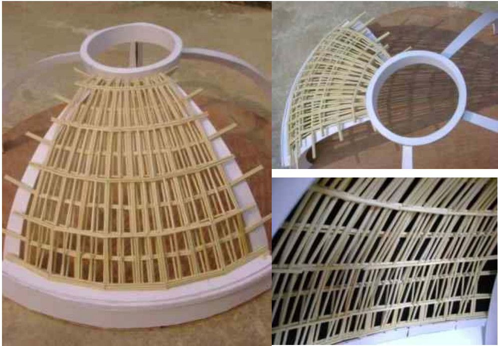
Fig. 141: Maqueta de posible distribución de las vigas de bambú. Fuente: Press Material
