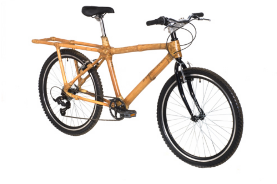
Fig. 28: Bicicleta construida con bambú. Fuente: La caña guadua como opción , de Cristóbal Cobo. http://www.terraecuador.net/revista_56/56_bambu.html
