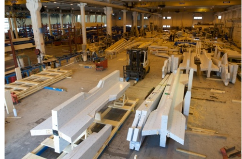
Fig. 188: Fabricación de las diferentes piezas de cada árbol. Para su traslado son protegidas con una cubierta de plástico. Fuente: Patrick Wack
