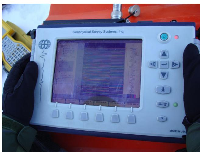
Figura 5.5. Pantalla de la unidad central del georradar.
