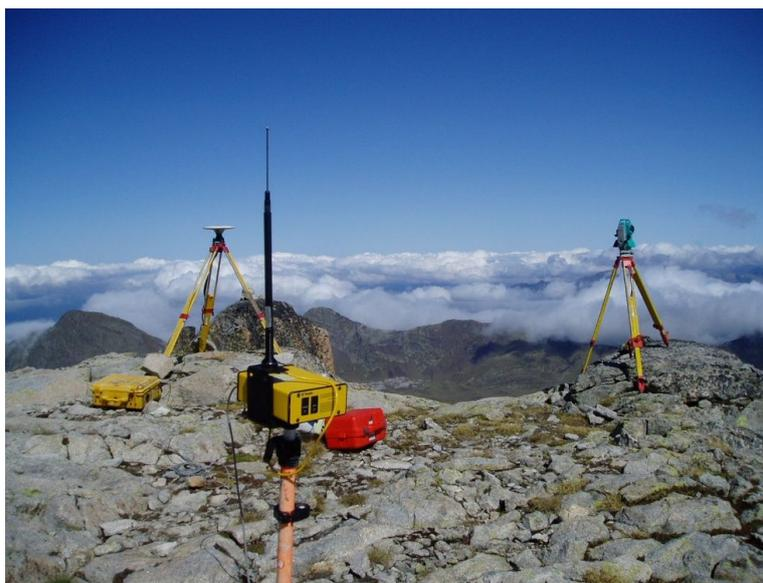
Figura 6.49. Bases topográfica utilizadas para la toma de datos GPS y coordenadas UTM por Topografía Clásica.
