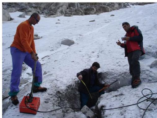
Figura 5.8. Perfil de calibración en el glaciar La Maladeta. Medida in situ del espesor del glaciar en una grieta de la parte baja del glaciar. Fotos de campo publicadas en el Anejo Fotográfico Glaciares 2008 programa ERHIN.
