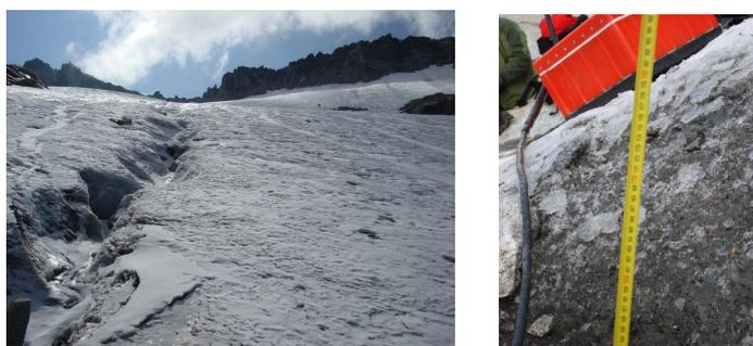
Figura 6.63. Grieta abierta, medida mediante flexómetro.
