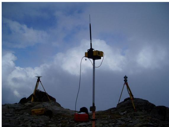
Figura 5.1. Equipo de medida con la tecnología GPSD y Topografía clásica.
