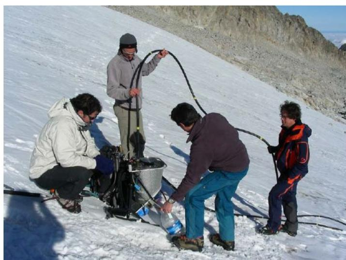
Figura 5.7. Medida in situ del espesor del glaciar mediante sondeo por sonda de vapor, para calibrar el georadar. Fotos de campo publicadas en el Anejo Fotográfico Glaciares 2008 programa ERHIN.
