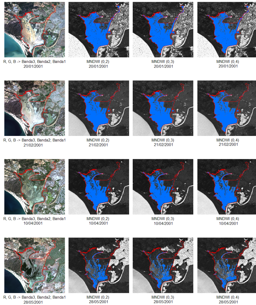
Figura 6.36. MNDWI con aplicación de distintos valores umbral en color azul. Contorno de marisma de Doñana en línea roja
