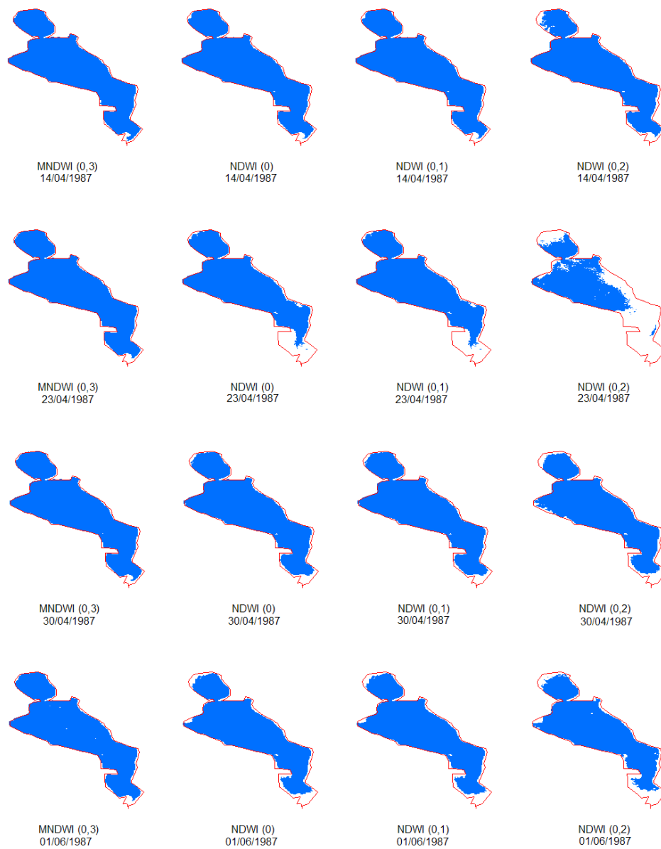
Figura 6.30. Comparación de superficies de lámina de agua identificadas mediante MNDWI y NDWI (varios umbrales) en laguna de Gallocanta
