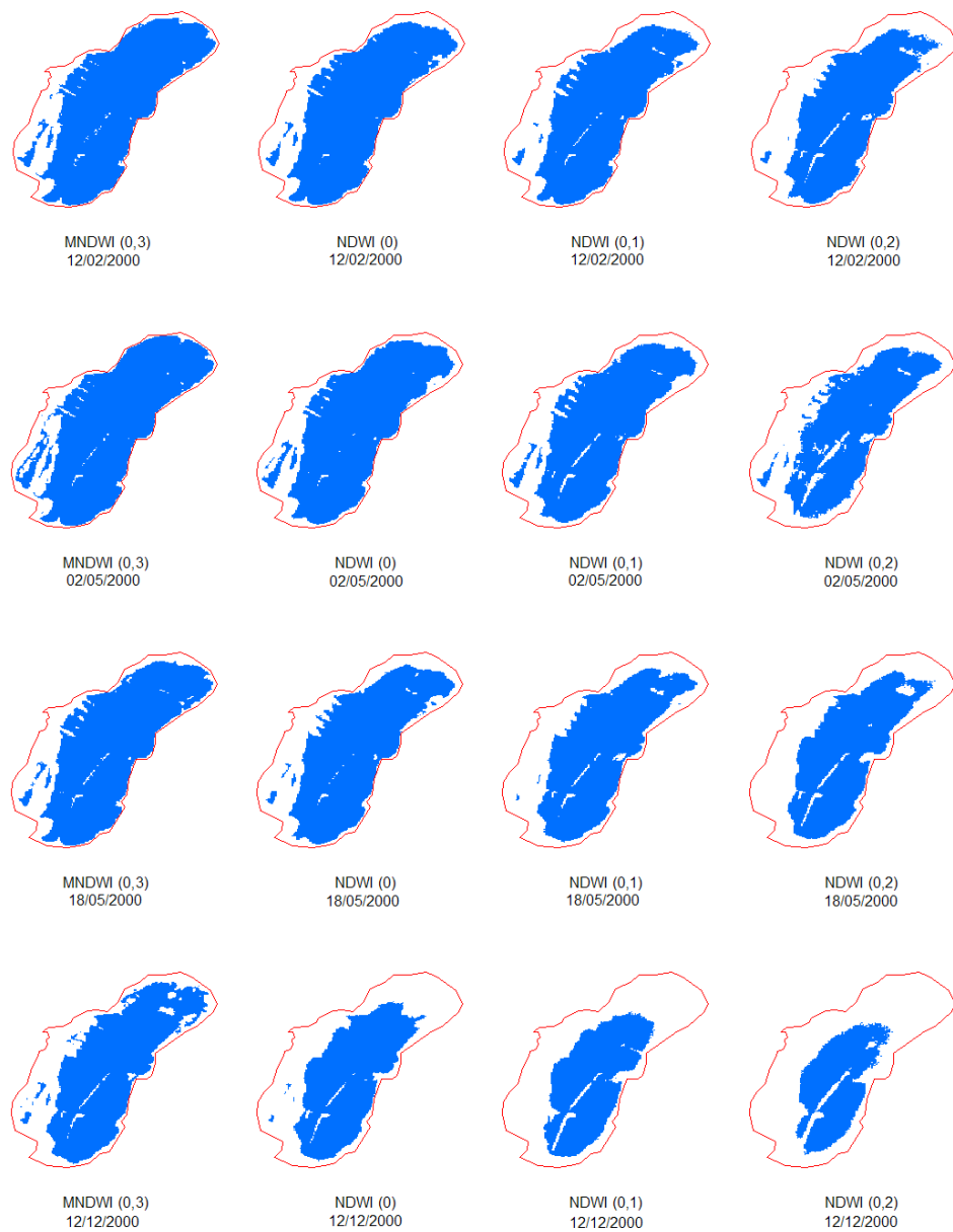
Figura 6.11. Comparación de superficies de lámina de agua identificadas mediante MNDWI y NDWI (varios umbrales) en laguna de Fuente de Piedra
