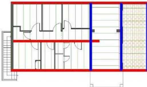
*Imágen 35. Segunda fase vigas apoyadas en muros de carga y pilares estado actual vivienda.
