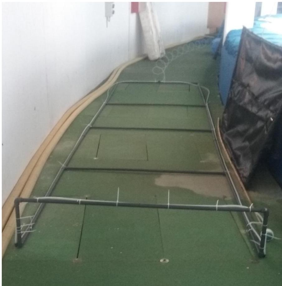
*Imagen 10: Estructura para la generación de burbujas.*
