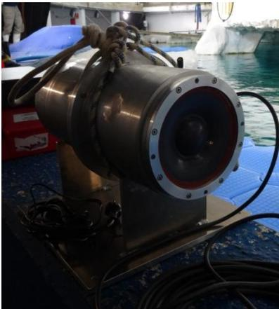
Prototipo diseñado por la Universitat d'Alacant en colaboración con la empresa Beyma, ideado originalmente para reproducir firmas acústicas de embarcaciones e instalaciones submarinas.
