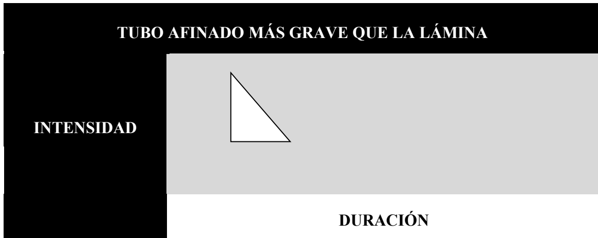
Figura 27.- Acústica del sonido cuando el tubo está afinado más grave que la lámina a la que amplifica
