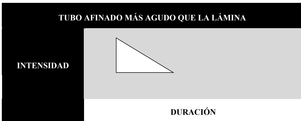
Figura 28.- Acústica del sonido cuando el tubo está afinado más agudo que la lámina a la que amplifica
