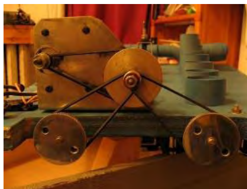
Figura 505.- Detalle de las gomas y discos giratorios del vibráfono "Vintage Galanti Vibraphonette"
