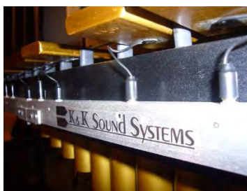
Figura 51.- Sistema K&K en un vibráfono
