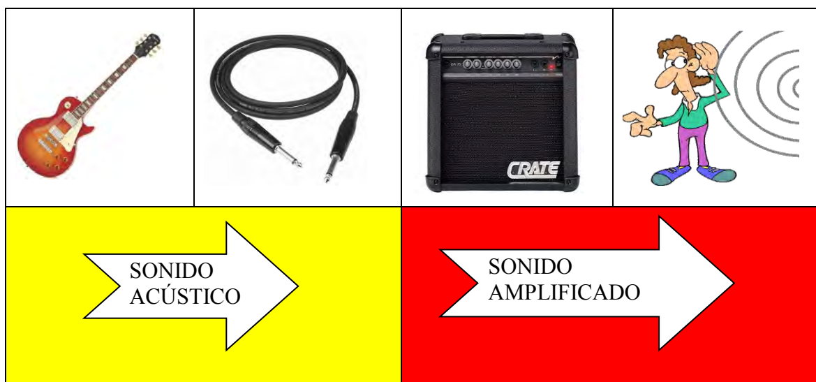
Figura 46.- Esquema de producción, amplificación y propagación del sonido en la guitarra eléctrica
