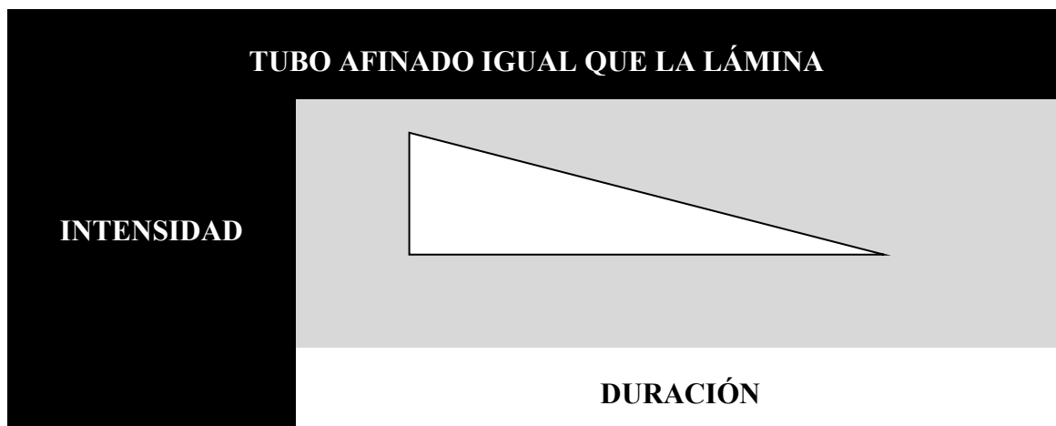
Figura 29.- Acústica del sonido cuando el tubo está afinado igual que la lámina a la que amplifica
