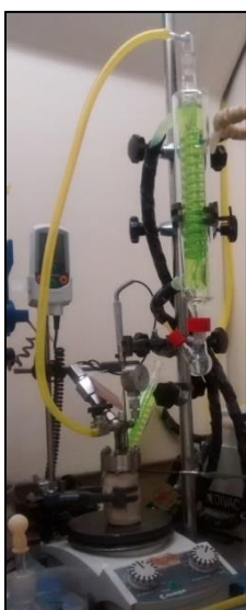
Imagen 3.2. Montaje de reacción empleado con el fin de desplazar el metanol mediante continuo burbujeo de N 2
