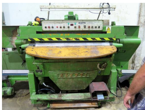
Fig. 190: Máquina de descarnar.
