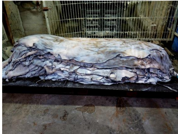
Fig. 192: Pieles descarnadas a punto del desescalado.
