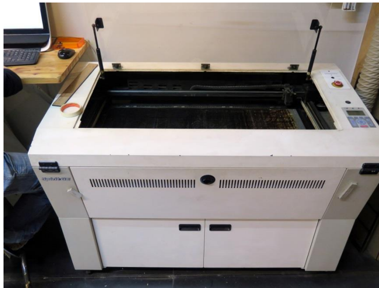
Fig. 312: Máquina Láser Spirit GE 100W con un área de trabajo de 965 x 610 x 177mm.
