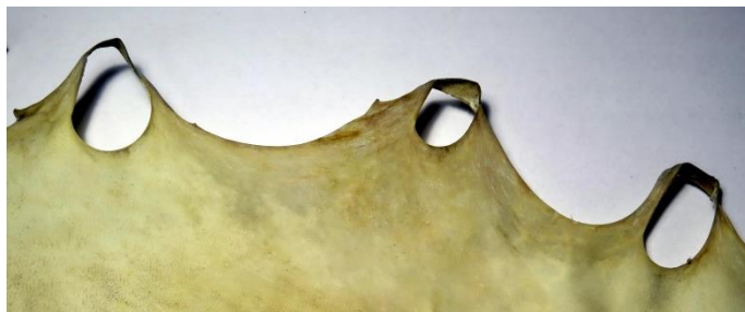
Fig. 210: Anclajes para el secado estirados por la tensión.
