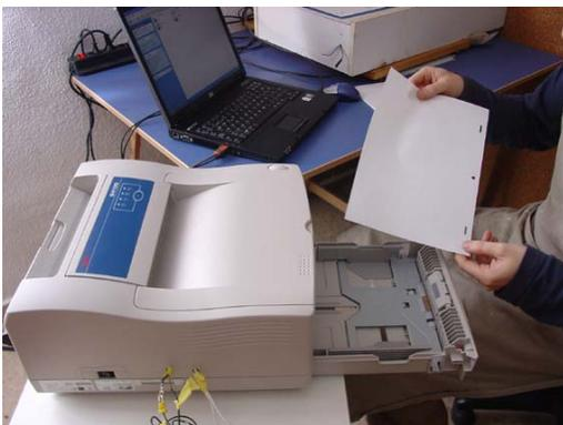
2) Se carga el depósito de la impresora con papel pivotado.
