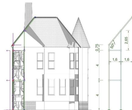
Hipótesis de colocación de andamio y sus anclajes a la fachada.
