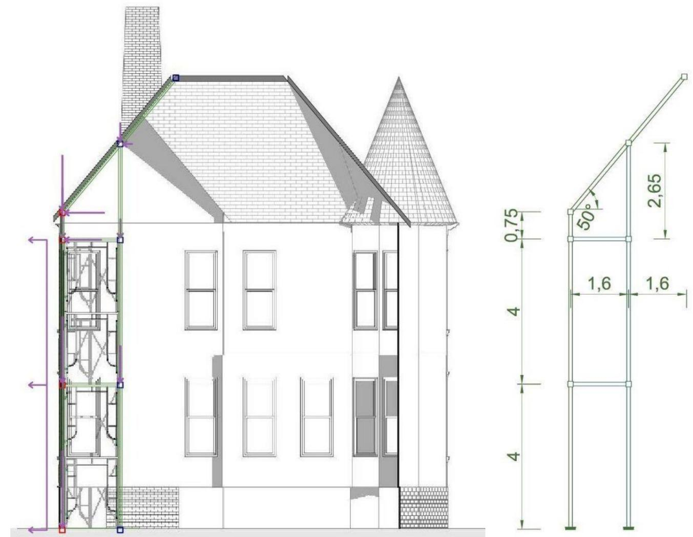
Imagen 124. Sección estructural con modelización, esquema de cargas y acotación.
