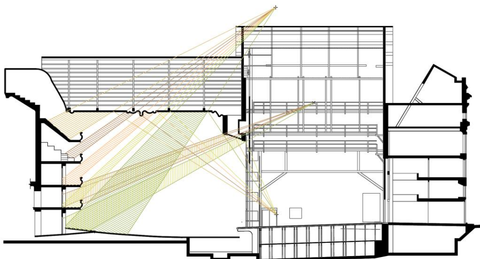
Figura 142 - Sección longitudinal. Reflexiones de primer orden procedentes del techo central de la sala y del arco de proscenio
