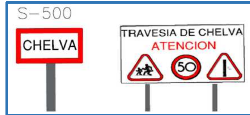
Figura 1 – Señalización instalada en la entrada de la travesía
