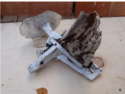
Fig. 23 Fig. 24 Detalle del proceso de elaboración y resultado de la fundición de las piezas metálicas.
