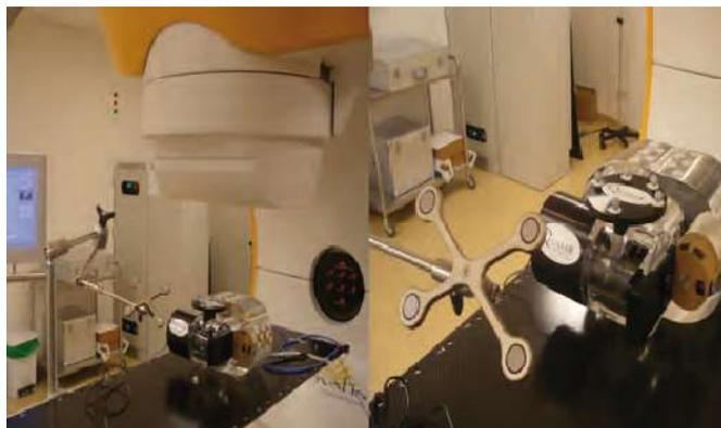
Fig. 18 Imagen general (izquierda) y detallada (derecha) del maniquí "QUASAR Test Motion Assay".
