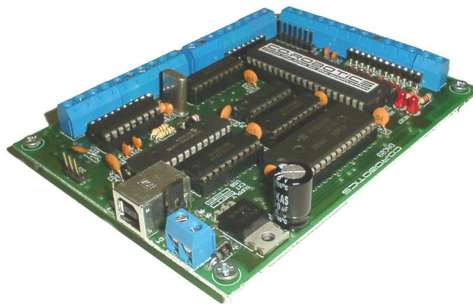
**Fig. 34 Tarjeta de adquisición de datos.**
