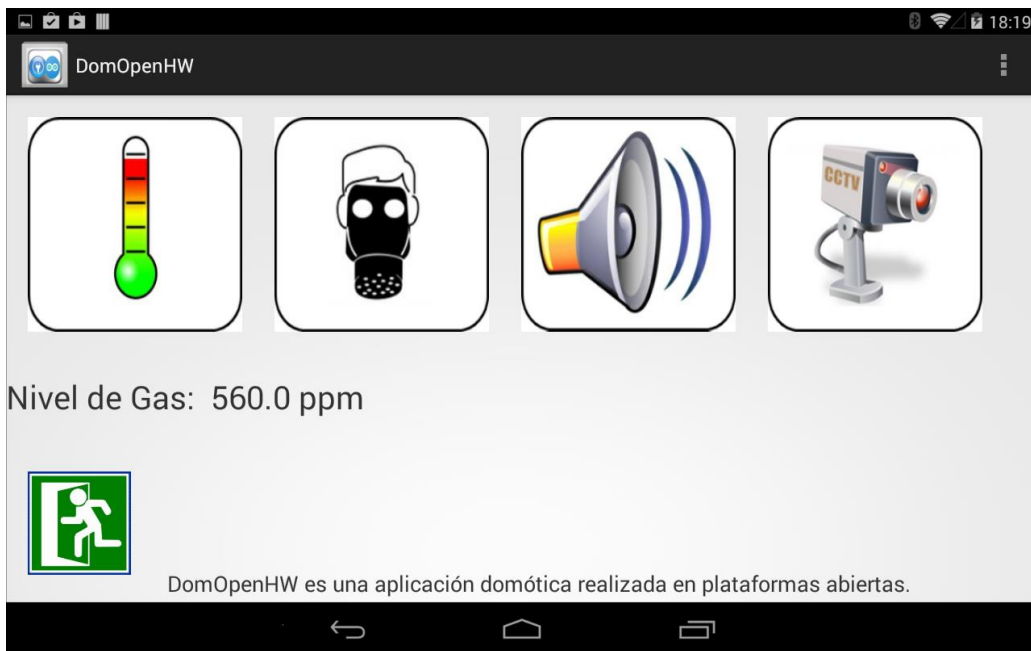
Figura 14. Aplicación Android mostrando el valor del sensor de gas.
