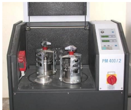
Fig 4.1 Molino planetario modelo PM 400/2 de Retsch.
