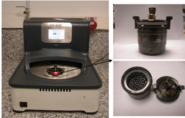
Fig 4.2 Molino planetario modelo Pulverisette 7 de Fristch.
