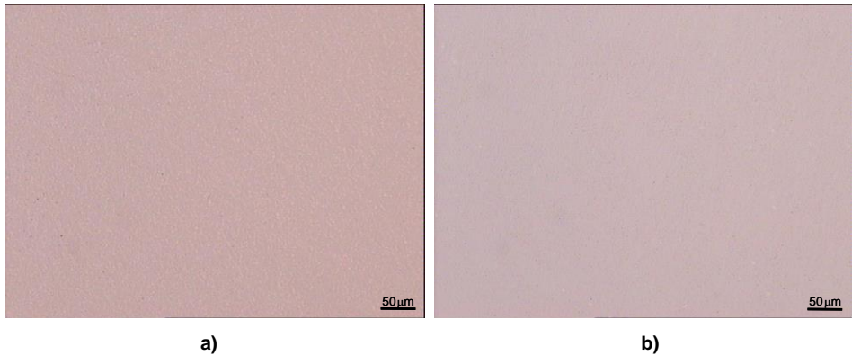
Fig 5.29 Imágenes de MO de los materiales de polvos nanocristalinas sinterizados a 1400 °C durante 30 min: a) M100, b) N25.
