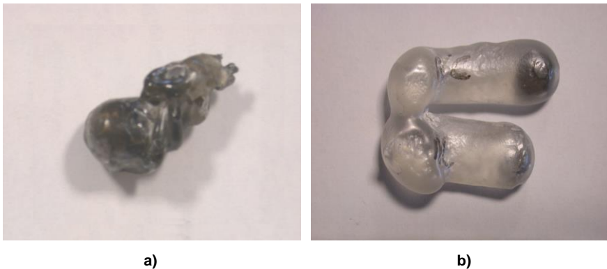
Fig 4.13 Capsulas tras el procesado HIP: a) con soplete, b) en horno de vacío.
