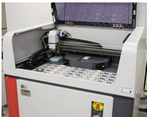
Fig 4.4 Difractómetro Bruker Theta modelo D8 Advance.
