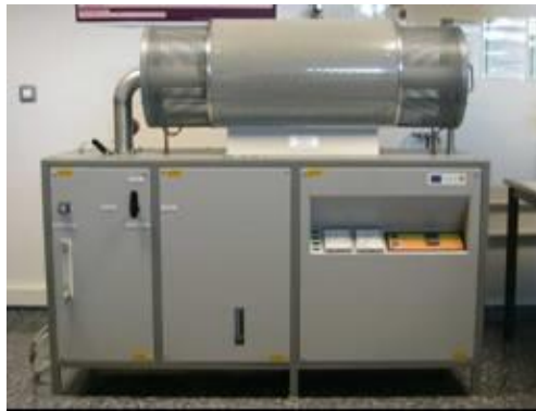
Fig 4.9 Horno de alto vacío Carbolite.
