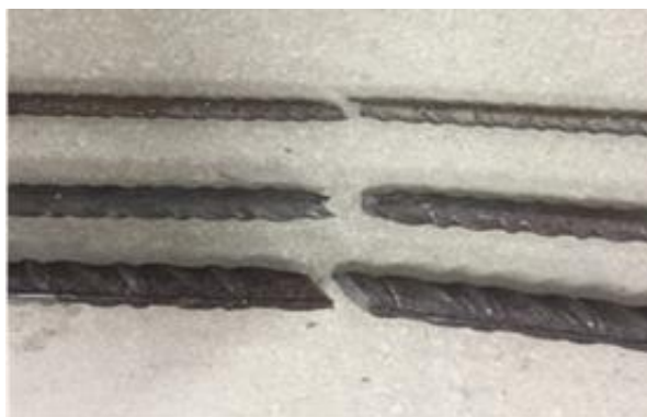
Figura IV.6. Ejemplo de barras de acero ensayadas a tracción según normativa. Lote 2
