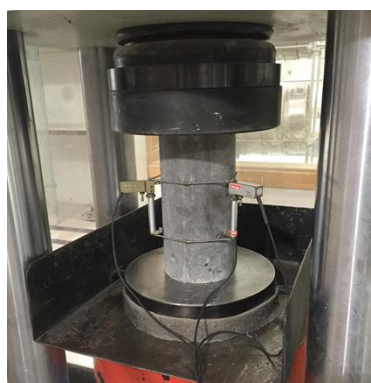
Figura V.44. Ensayo para la obtención del módulo de deformación en compresión del hormigón
