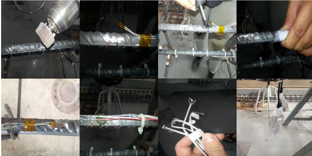
Figura V.23. Distintas fases del pegado de las bandas extensométricas
