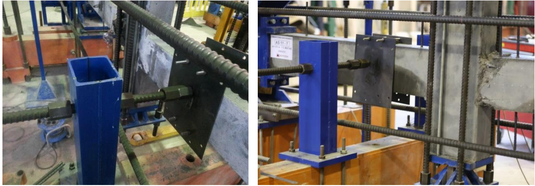
Figura V.15. Sistema de control de pandeo lateral
