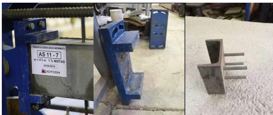
Figura V.14. Sujeción del soporte al pórtico de ensayo. Vista de la placa que recibe el elemento. UPN modificado
