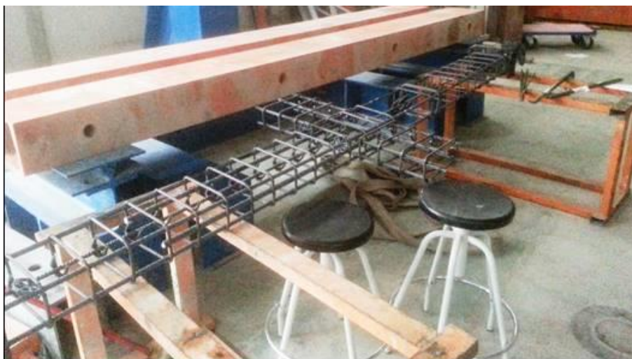
Figura V.21. Ferralla modificada según programa experimental previsto
