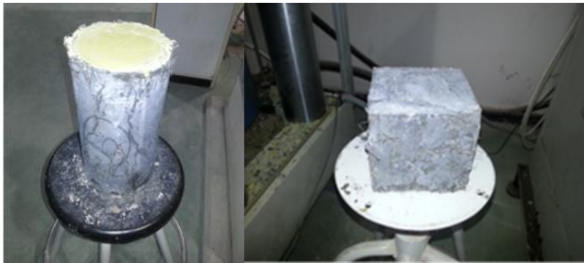
Figura IV.2. Ejemplo de probeta cilíndrica y cúbica realizada para control del hormigón
