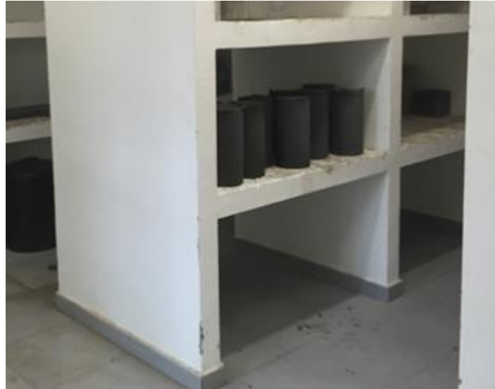
Figura V.33. Conservación de las probetas de control en cámara húmeda
