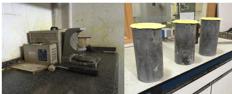
Figura V.42. Equipo para refrentar y probetas cilíndricas refrentadas
