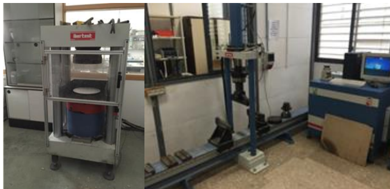
Figura IV.4. Prensas para la ejecución de los ensayos a compresión simple y flexotracción.
