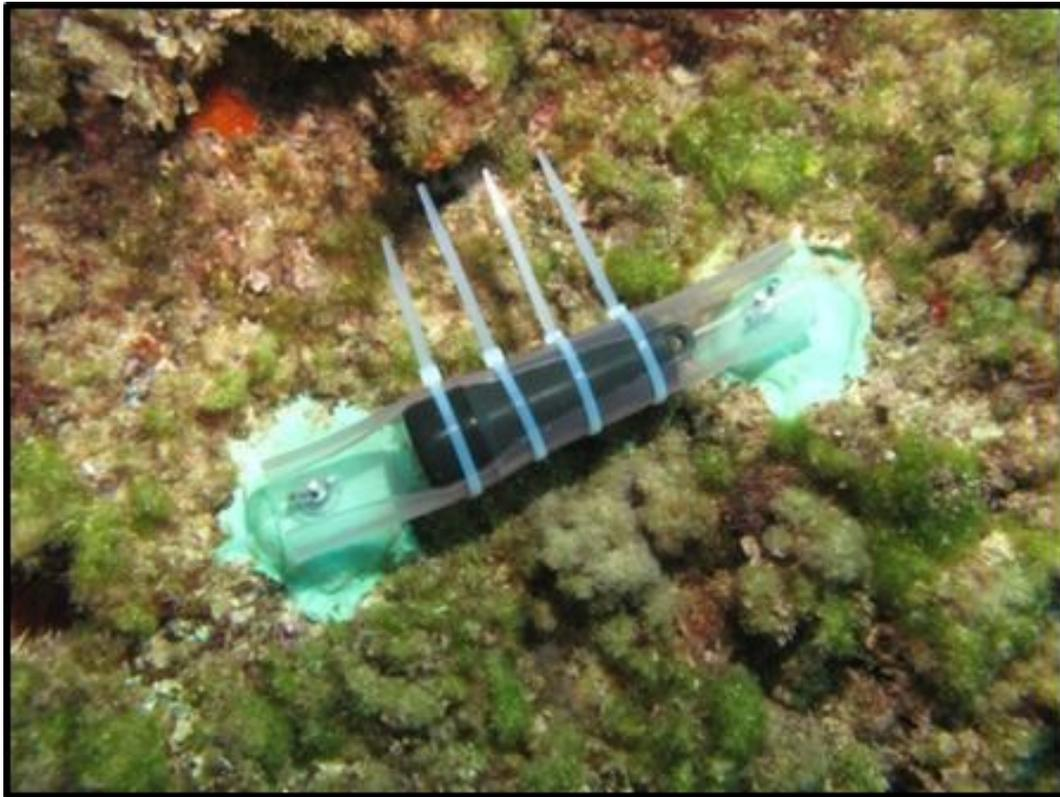
**Fig. 4.10. Instrumento de registro de temperatura. Soporte y sensor de temperatura HOBO instalado a 17 metros de profundidad.**
