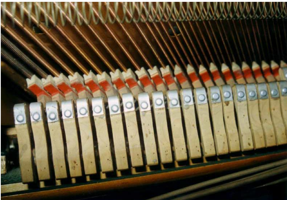
Preparación de los macillos para el piano n.º 2: Fotografía: Jürgen Hocker. 335
