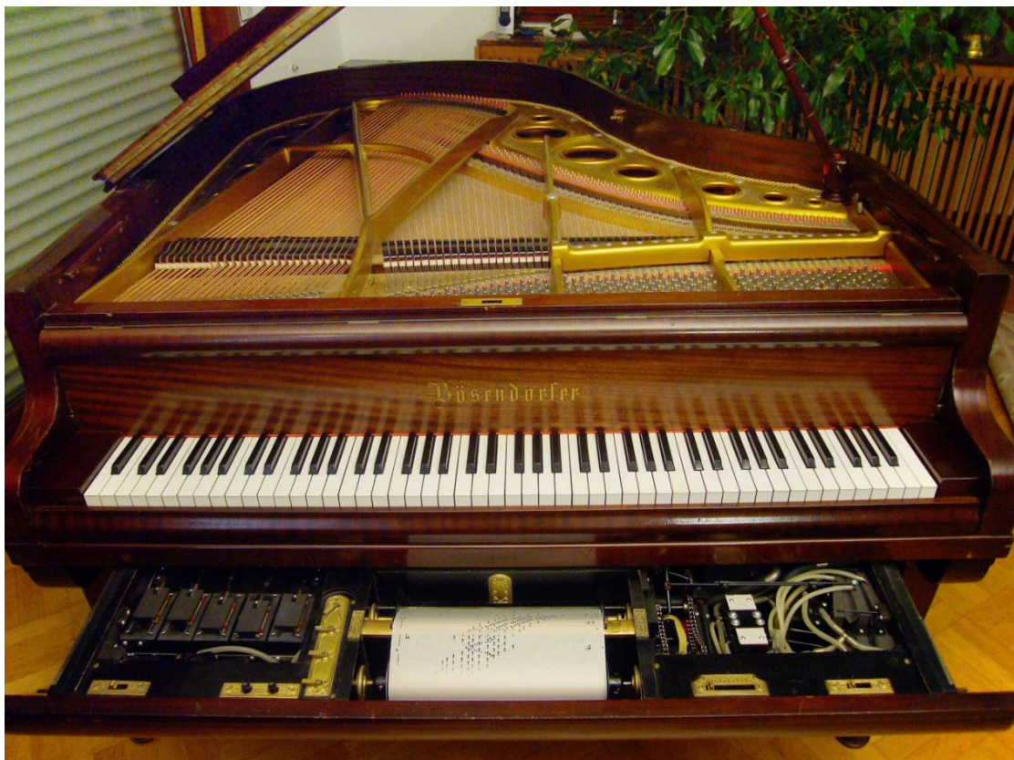
Uno de los pianos de reproducción automática con el sistema Ampico-Bösendorfer, de 1927. El rollo de la caja de música se sitúa en un cajón extraíble bajo el teclado.
