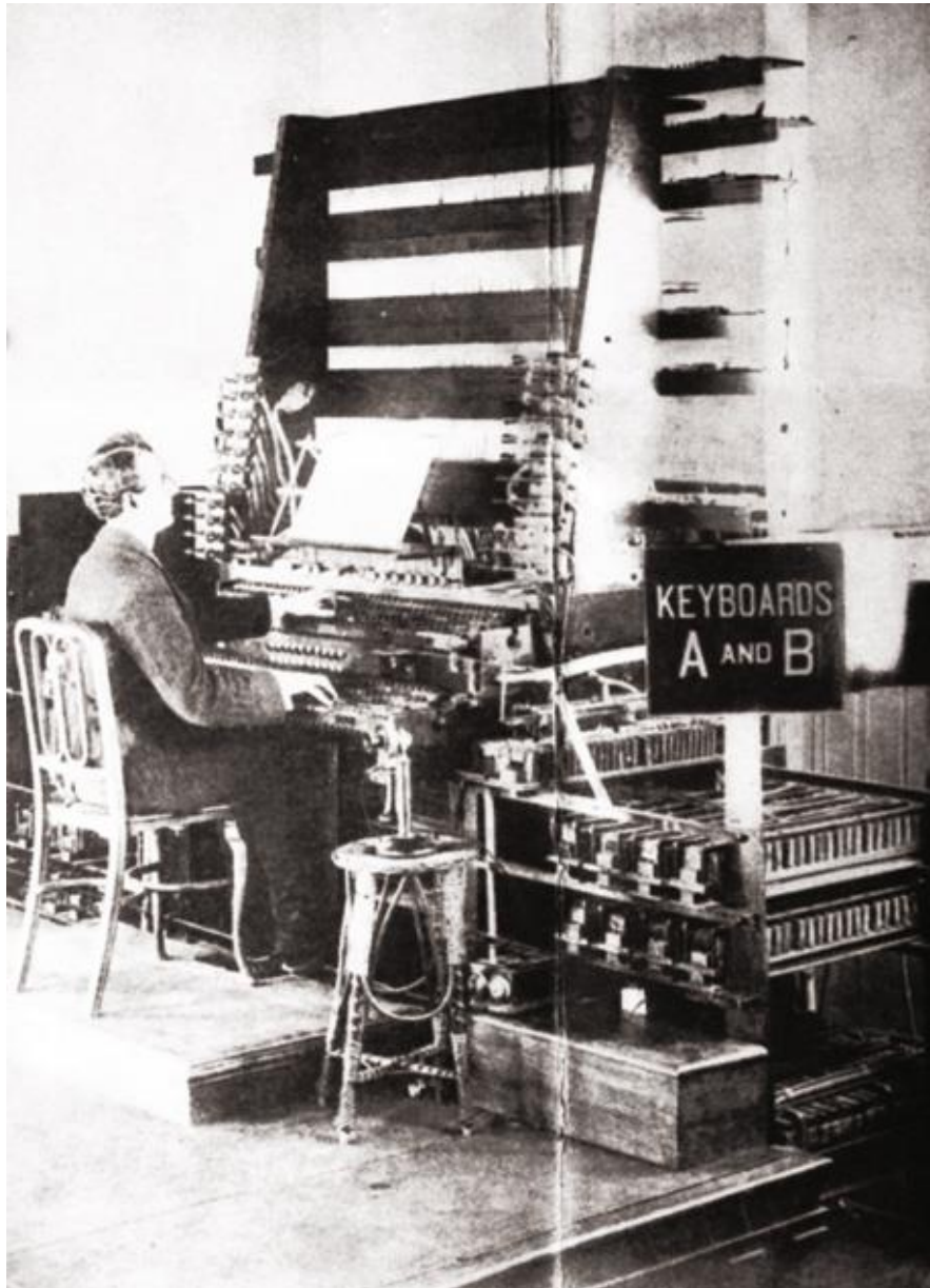
El control de teclado dual del telharmonium (1907). 432
