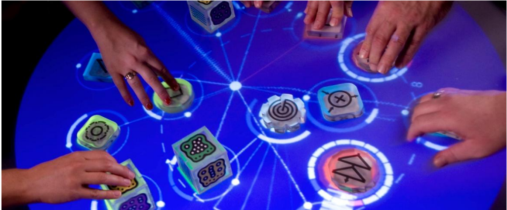
Figura 17: Ejemplo de Superficie Interactiva Digital que permite interactuar mediante elementos tangibles: reacTable.
