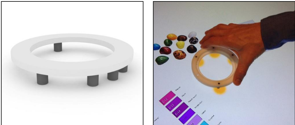
Figura 67: Detalle de los manipuladores tangibles desarrollados. Modelo 3D (izquierda) y caso de uso real sobre un tabletop de marco óptico (derecha)
