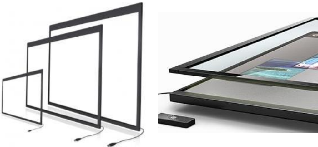
Figura 64: Ejemplo de marcos ópticos multitáctiles, basados en tecnología de luz infrarroja.
