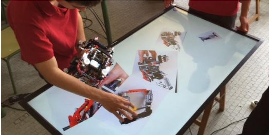
Figura 65: Ejemplo de dispositivo tabletop utilizado en la investigación, implementado mediante un marco óptico infrarrojo y una pantalla plana de televisión.
