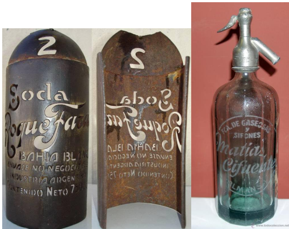
Ilustración 122. Molde para impresión al chorro de arena y ejemplo de sifón rotulado bajo esta técnica 193 .
