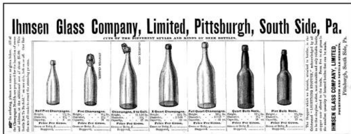
Ilustración 106. Publicidad de la empresa Ihmsen Glass Company, Limited (1876-1896) de Pittsburgh donde se detallan las características morfológicas de sus diseños, así como tamaños y opacidad (entendemos que debían ser colores, pero hemos obtenido la muestra en blanco y negro) 178 .
