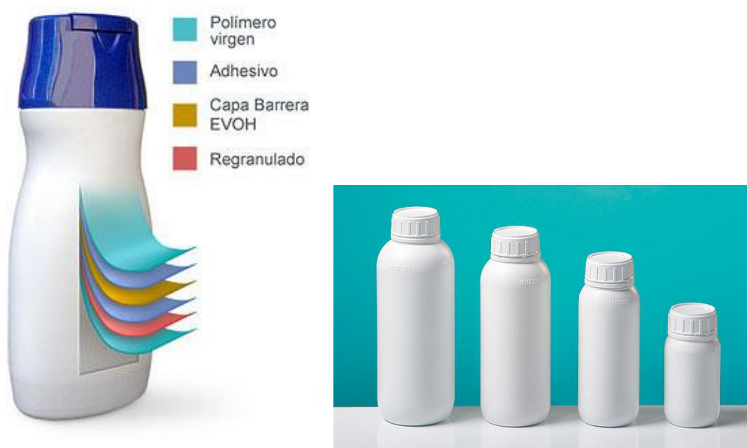
Ilustración 183. Izquierda: Desglose esquemático de componentes de una botella multicapa con material barrera EVOX. Derecha: Botellas multicapa de plástico de plástico con capa barrera, fabricadas mediante coextrusión. Se trata de botellas para contener productos agroquímicos. Botellas cilíndricas de: 1000ml. de \varnothing 88,5 x 239,5 (mm), 750 ml. de \varnothing 88 x 218 (mm), 500ml. de \varnothing 69 x 189 (mm), y 250ml. de \varnothing 62,5 x 128 (mm). En todos los envases, cuello tipo KS 50. Empresa fabricante Alcion Plásticos 296 .
