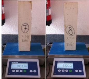
**Figura 71** Pesadas del ensayo de pérdida de peso
