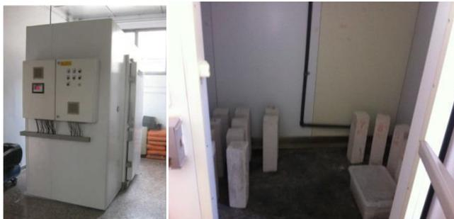
**Figura 70** Cámara de curado 20°C y 50% Humedad (a) Exterior (b) Interior
