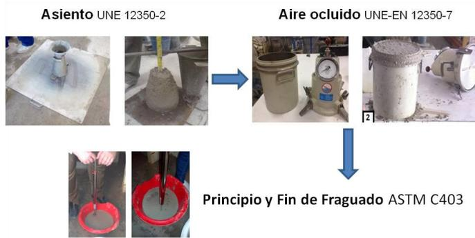
Figura 49 Equipos ensayos HCV fresco
