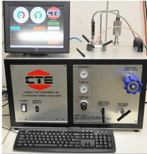
Figura 17. Equipo Ultrasonic Cement Analyzer (Shuker et al., 2014)
