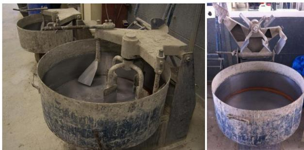
**Figura 48** Amasadora planetaria de 70 litros
