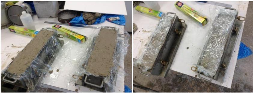
**Figura 64** Probetas retracción autógena
