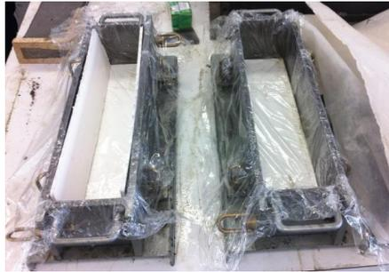
**Figura 63** Preparación de los moldes en el ensayo de retracción
