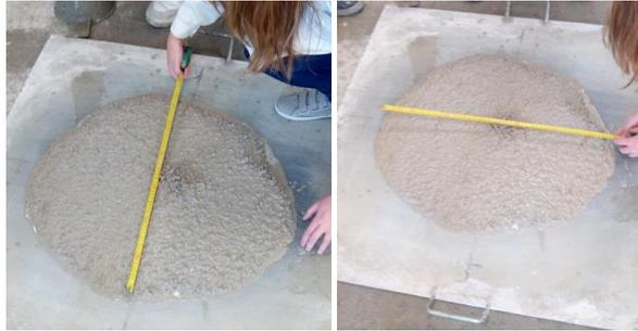
**Figura 51** *Medición diámetros*
