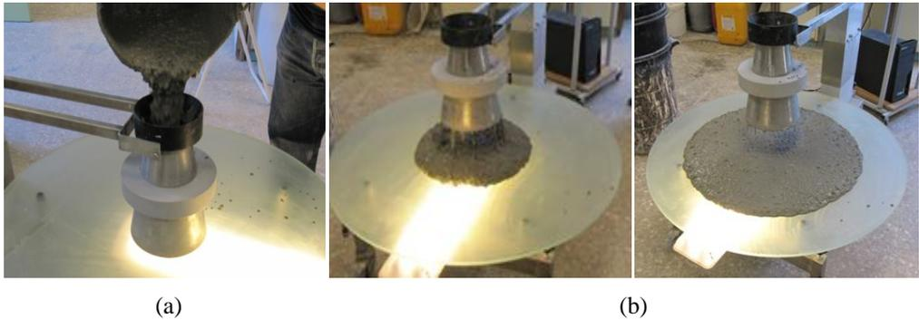
**Figura 53** (a) *Vertido del hormigón* (b) *Ensayo*
