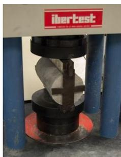
**Figura 61** *Dispositivo de ensayo a tracción indirecta*
