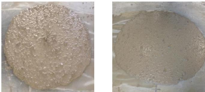
**Figura 74** Ecurrimiento hormigones AC20A60 y AC12A70
