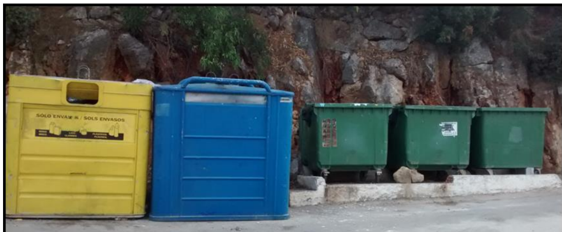
Imagen 5.357. Contenedores no accesibles por su ubicación desde la acera y con una altura de boca que los hace inaccesibles para usuarios en silla de ruedas.
