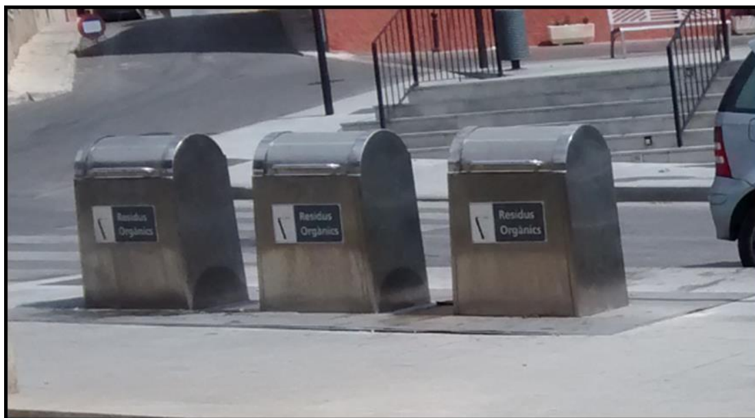
Imagen 5.368. Contenedores totalmente accesibles. Se pueden acceder a ellos desde la acera y la boca se encuentra a 0,7 m del suelo. Fuente: imagen propia.
