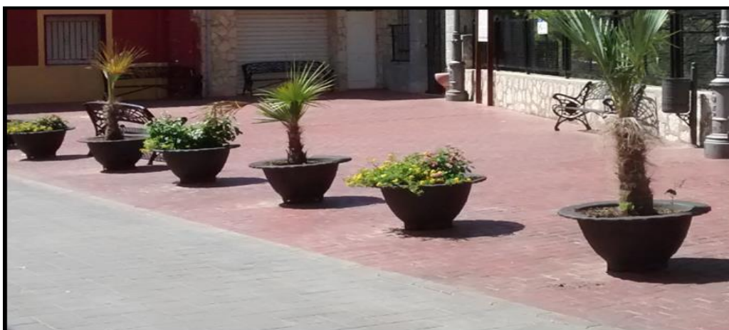
Imagen 5.493. La existencia de este tipo de maceteros en algunas zonas públicas constituye un peligro de tropiezo para personas con deficiencia visual debido a que no se proyectan hasta el suelo. Fuente: imagen propia.
