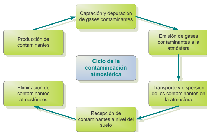
Figura 1: Diagrama de flujo del ciclo de la contaminación atmosférica
