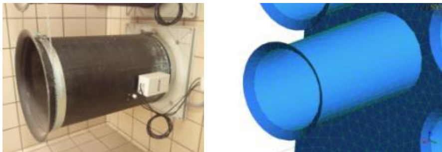
Figura 66: Idealización en el mallado de los rebordes de las toberas
