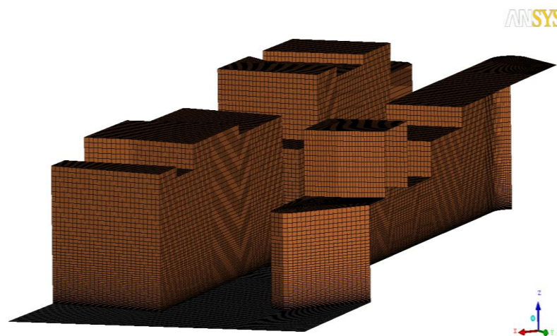
Figura 131: Vista en perspectiva del mallado del dominio computacional
