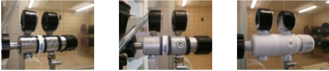
Figura 74: Proceso de congelación del manorreductor usado en las pruebas
