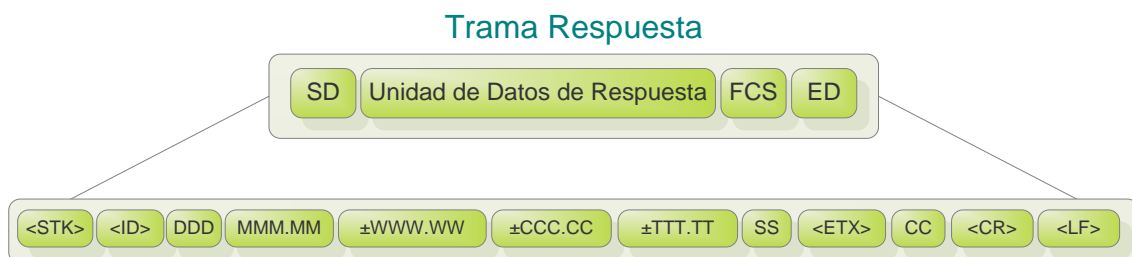
Figura 55: Trama de respuesta del anemómetro sónico GILL Wind Master
