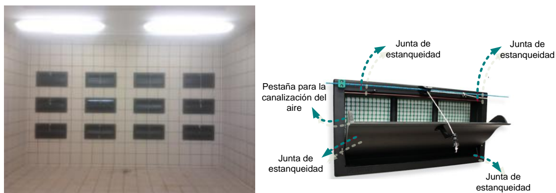
Figura 59: Imagen de la pared Oeste de la sala con las doce ventanas abatibles (izq.) y sistema para la apertura de la ventana (der.)
