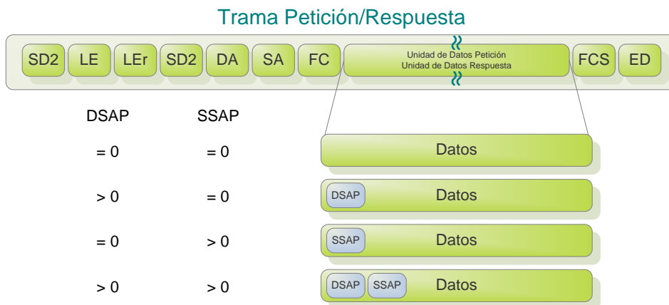
Figura 36: Servicios SAP en el protocolo PROFIBUS para los dispositivos Gantner
