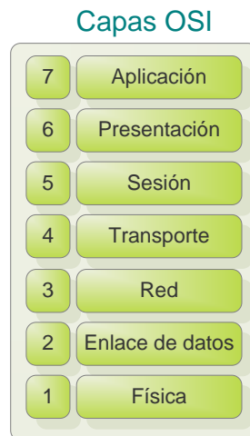
Figura 13: Esquema representativo de las diferentes capas del modelo OSI
