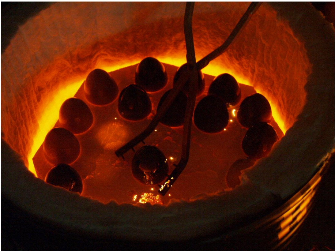
Imagen 61 y 62. Piezas dentro del horno a 850°C
