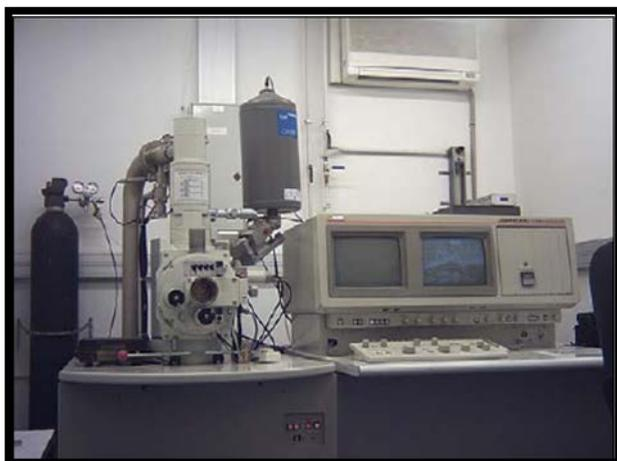
Figura 4.7. Microscopio electrónico de barrido del S.M.E.
