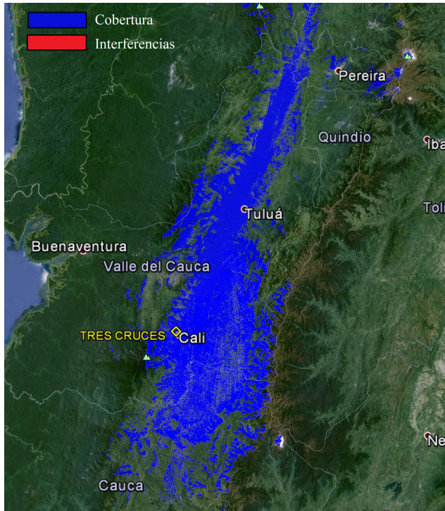
Figura 4.4: Interferencias sobre la red analógica desde la red digital para el canal N+1 con todos los emplazamientos emitiendo con la misma potencia (5000 W).
