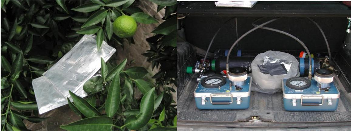
**Figura 14.-** Medida del potencial hídrico del tallo o de hoja embolsada con la cámara a presión.
