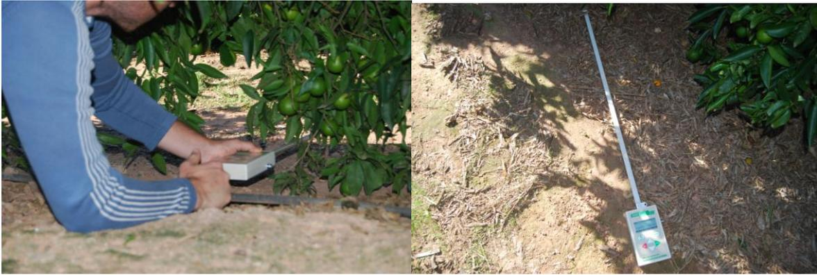
**Figura 16.-** Medida de la interceptación de PAR por parte de la copa con el ceptómetro.
