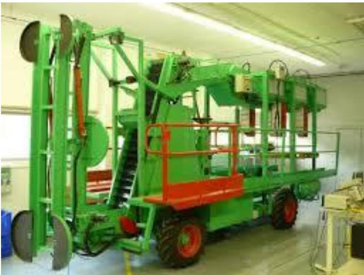
**Figura 2.-** Plataforma de recolección autopropulsada diseñada en el IVIA.
