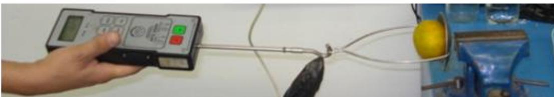
**Figura 10.-** Determinación de la FRF con el dinamómetro.
