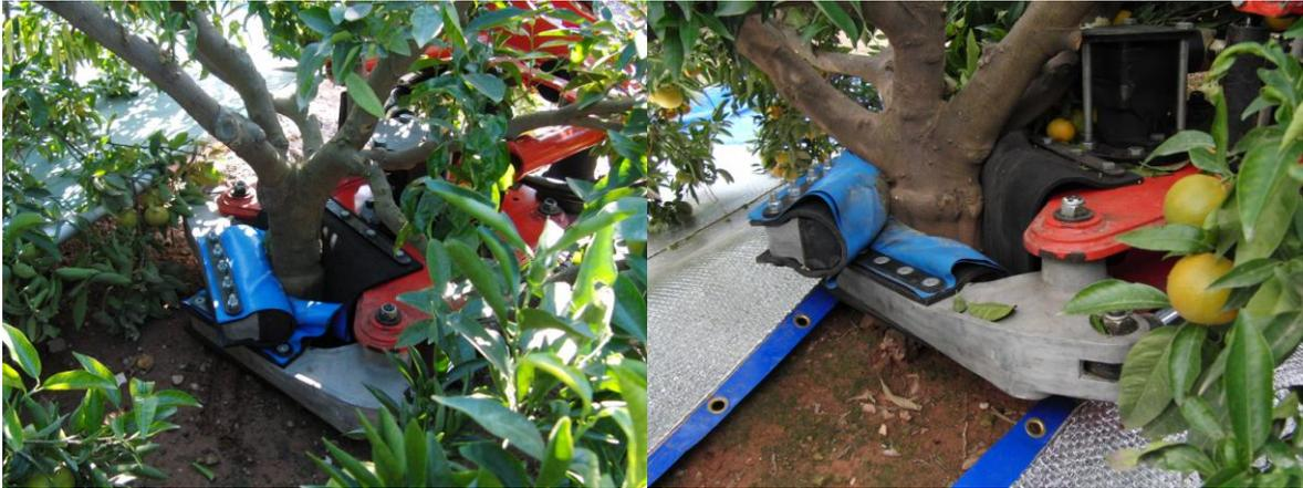
**Figura 7.-** Vibrador de troncos utilizado en los ensayos y detalle de cómo la pinza abraza al tronco para realizar la vibración.
