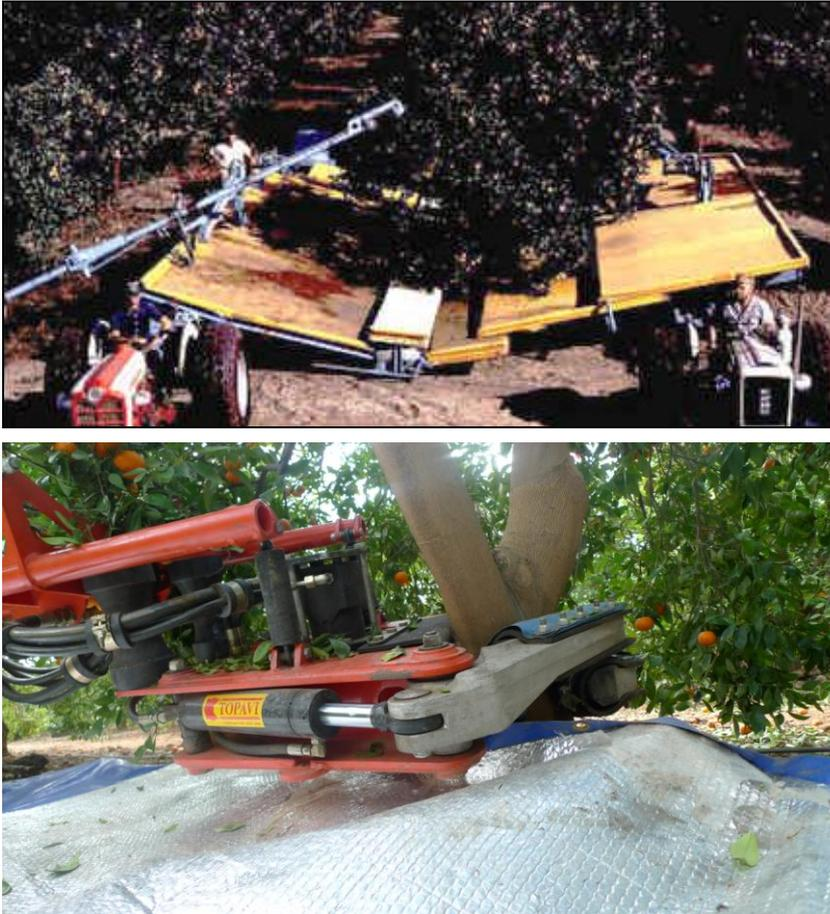
**Figura 5.-** Arriba. Vibrador de ramas. Abajo. Vibrador de troncos.
