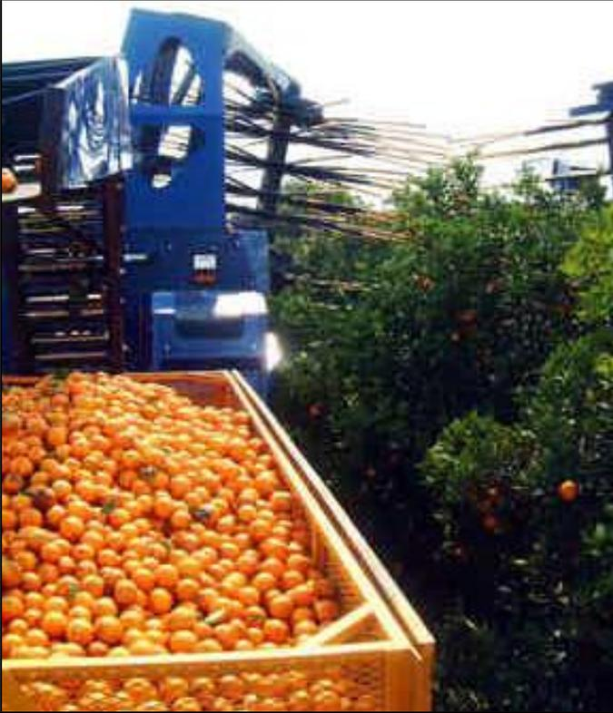
**Figura 3.-** Máquina vareadora.
