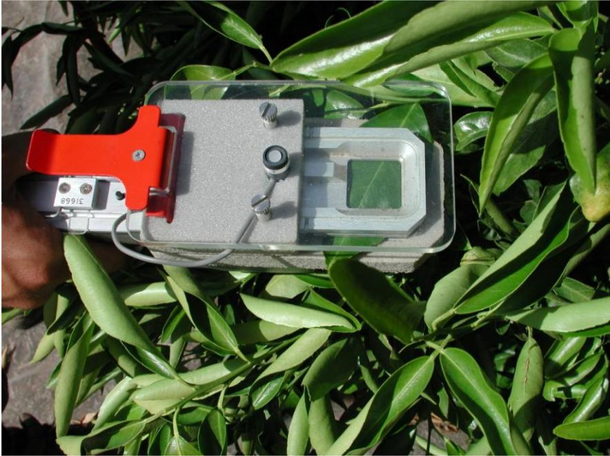
**Figura 15.-** Medida de la conductancia estomática, fotosíntesis y transpiración con el medidor de intercambio gaseoso.
