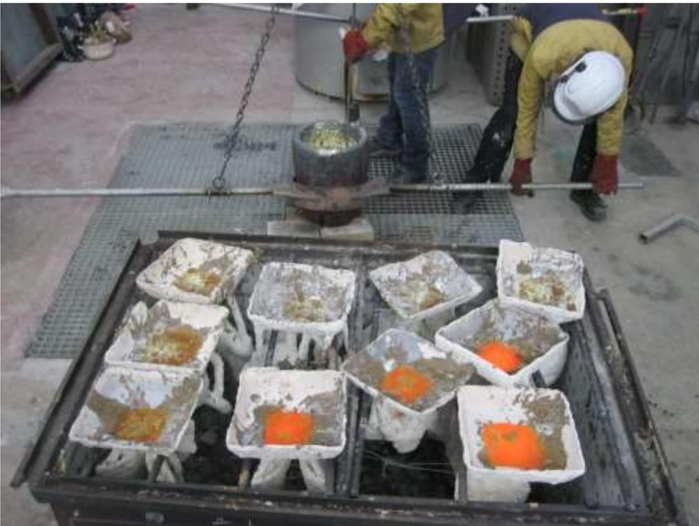
Cuando descaramos las primeras piezas, quedo un hueco en la cerámica, por donde vertimos el metal, y dejamos enfriar, para posteriormente romper la cascarilla y cortar los sobrantes.
