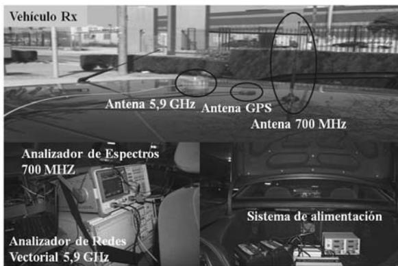
**Figura 2.** Imagen del vehículo Rx junto con el equipamiento de a bordo.
