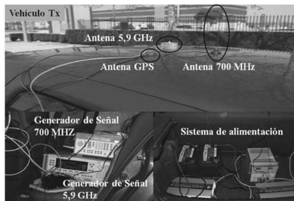
Figura 1. Imagen del vehículo Tx junto con el equipamiento de a bordo. Fuente: elaboración propia.
