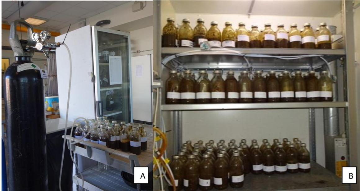
*Figura 6. Lavado de botellas con N<sub>2</sub> (A). Digestores en lote en incubación a 50 °C durante 90 días (B)*
