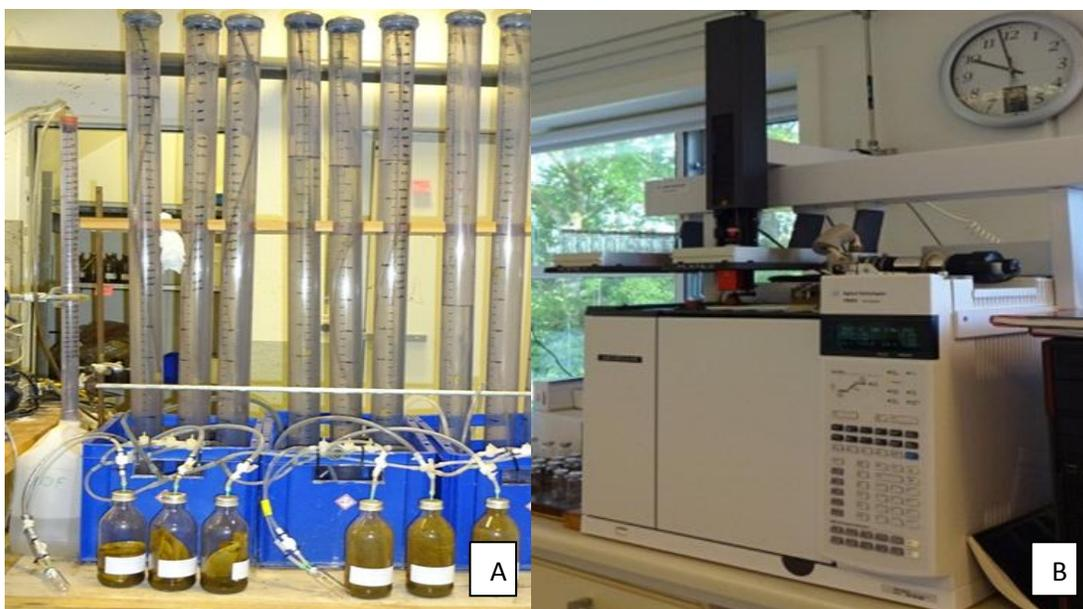
Figura 7. Obtención de biogás acumulado en cada digester de lote (A). Determinación de los componentes del biogás a través del cromatógrafo de gases (B)
