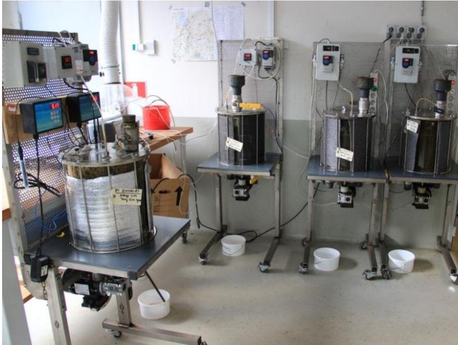
*Figura 3. Funcionamiento de digestores anaerobios de tanque agitado continuo de donde se obtuvo el inóculo*
