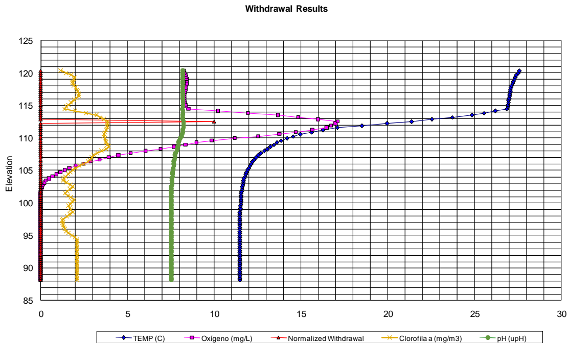
Figura 46. Resultados gráficos de extracción de agua, mediante el procedimiento A). Día 15 de Agosto_tarde de 2012.
