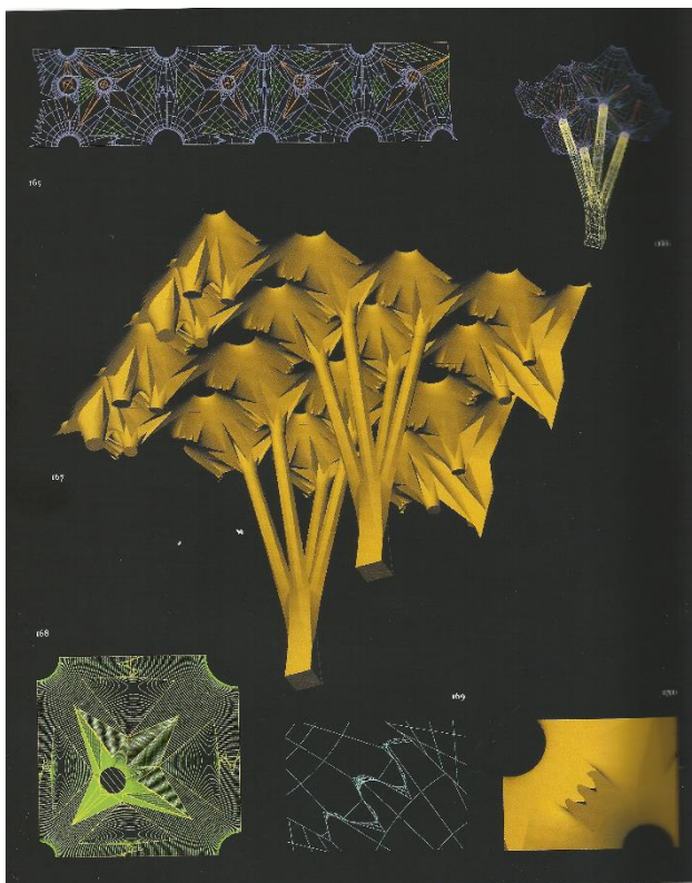
Franja básica de la bóveda en nave lateral. Fuente: Gomez Serrano, J. y AA.VV. (2008). Sagrada Familia XXI/ Gaudí ara . Barcelona. Edicions UPC.
