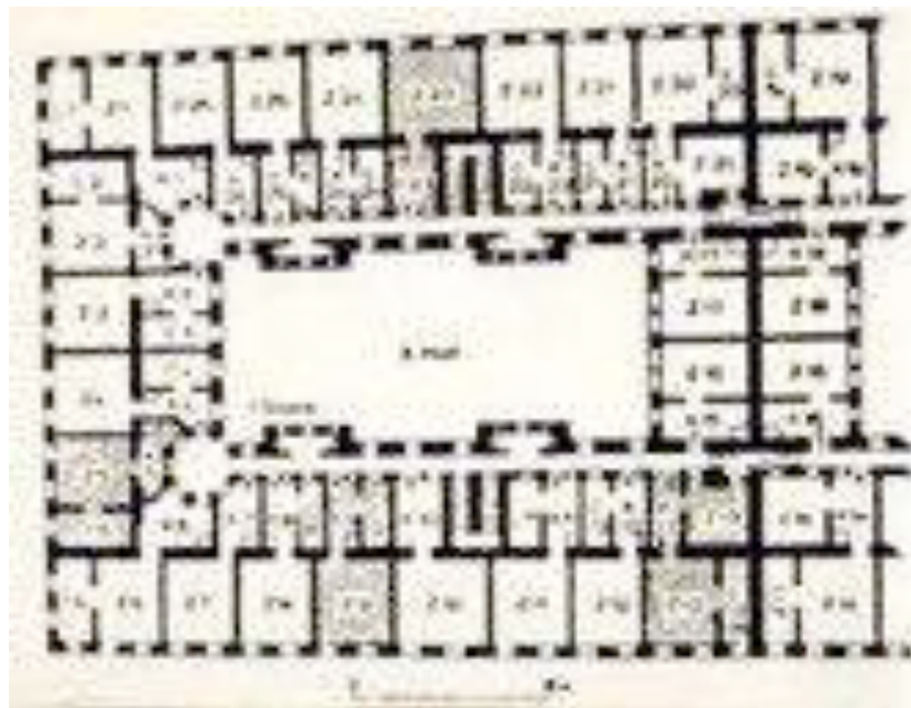
Fig.-5.25. Planta de una casa de vecindad o "Miettkasernen" vienesa. (Blat 2000, p.32).
