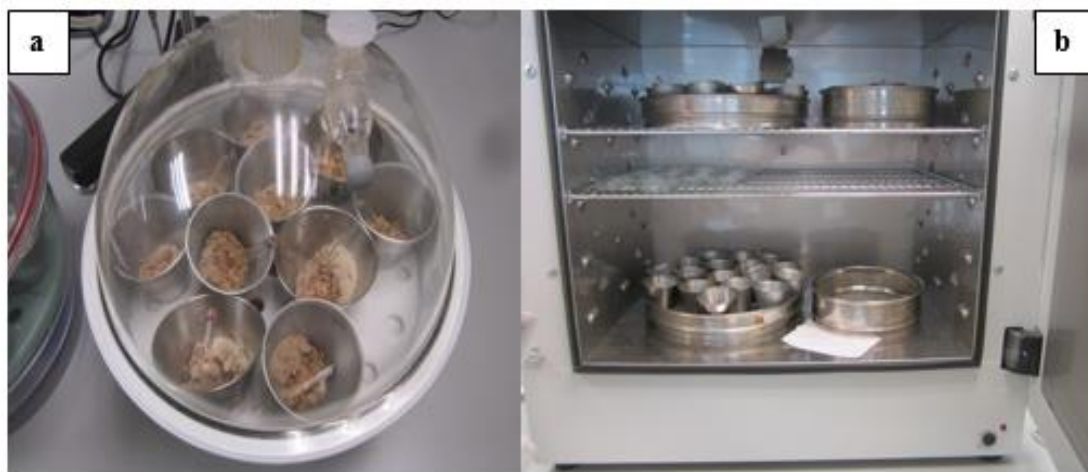
Figura 6. Flaneras de aluminio, varillas de vidrio y arena de mar empleados en la determinación de la humedad de la carne de seriola (a). Estufa (b).
