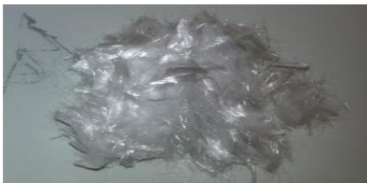
Figura 38 Fibras Micro sintéticas.
