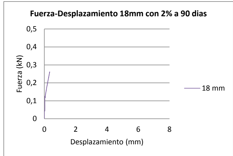
Figura 72 Izquierda muestra con fibras de 12 mm ensayada a 90d con 2% de fv en su dosificación, derecha muestra con fibras de 18 mm ensayada a 90d con 2% de fv en su dosificación.
