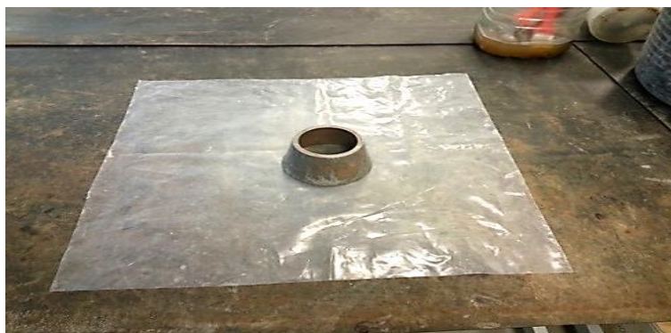
Figura 41 Cono de Abrams para morteros.
