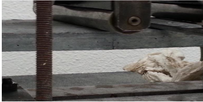
Figura 52 Fisura en muestra con fibras de vidrio de 36 mm.
