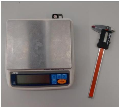
*Fotografía 3.32. Balanza de precisión y pie de rey digital*
