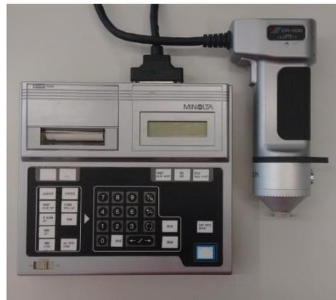
*Fotografía 3.33. Colorímetro usado en el ensayo MINOLTA CR-200*
