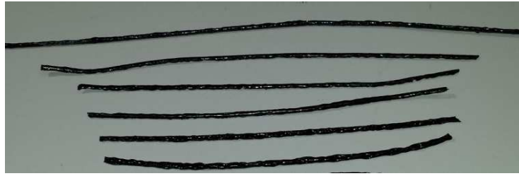
Figura.- 22 FILAMENTO EXTRUIDO DE PLA/MWCNTS 1%
