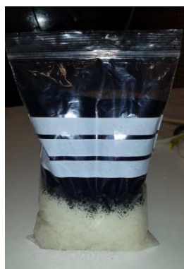
Figura.- 13 VOLUMEN DE MEZCLA DE PLA Y MWCNTs A 5%
