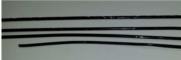
Figura.- 23 FILAMENTO EXTRUIDO DE PLA/MWCNTS 0.5%
