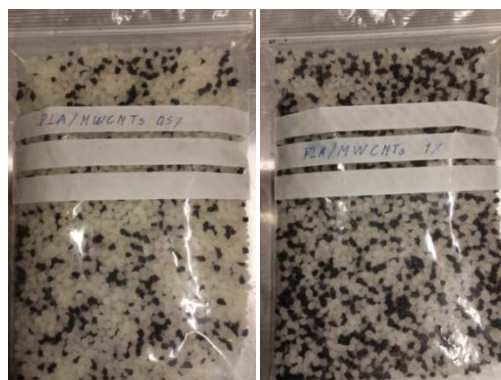
Figura.- 16 CANTIDAD DE MASTERBATCH Y PLA PARA OBTENCIÓN DE NANOCOMPUESTO DE 0,5 y 1% de MWCNTs.
