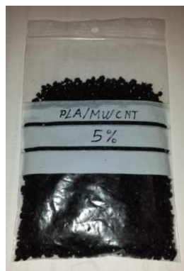
Figura.- 15 MASTERBATCH DE PLA /MWCNTs 5%
