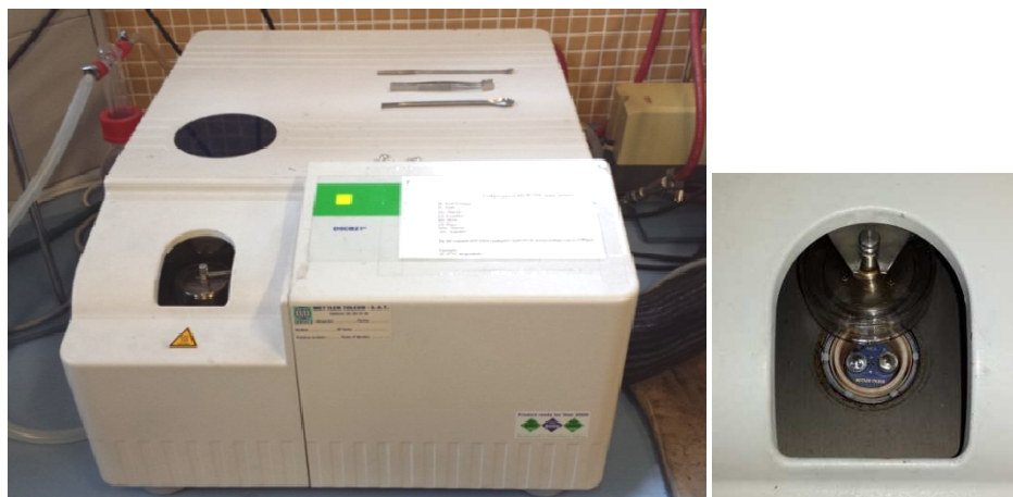
Figura.- 17METTLER-TOLEDO 821, DETALLE DEL CRISOL O PORTA MUESTRAS - DEPARTAMENTO DE INGENIERÍA MECÁNICA Y MATERIALES - UPV ALCOY
