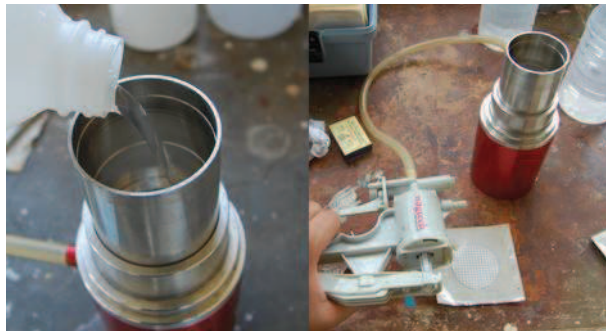
Figura 40. Llenado del tubo de filtración con la muestra de agua y succión.
