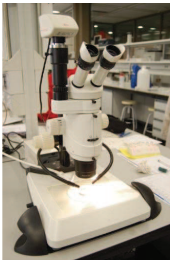
Figura 45. Estereomicroscopio utilizado en la identificación de las familias de macroinvertebrados (LEICA MZ16 y cámara DFC420).
