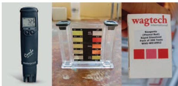
Figura 27. Medidor de pH, test de colorimetría y reactivo (rojo fenol)
