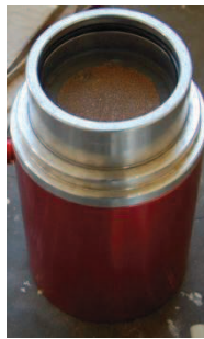
Figura 37. Soporte de membrana y vaso de filtración.
