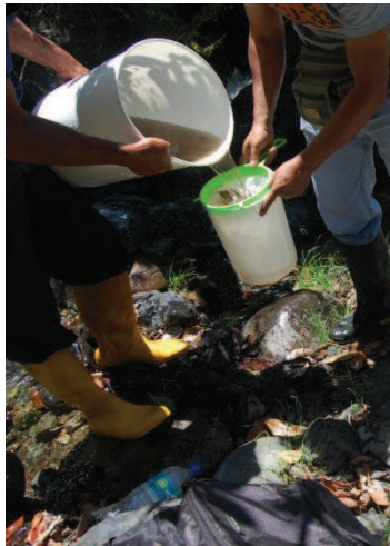
Figura 33. Filtrado del exceso de agua de la muestra.
