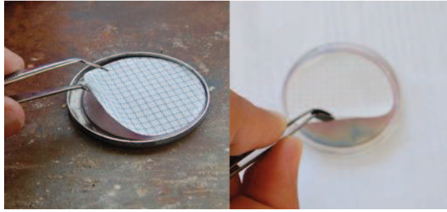
Figura 42. Colocación de la membrana sobre el medio de cultivo.
