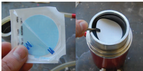
Figura 38. Colocación de la membrana de celulosa sobre el soporte del aparato de filtración.
