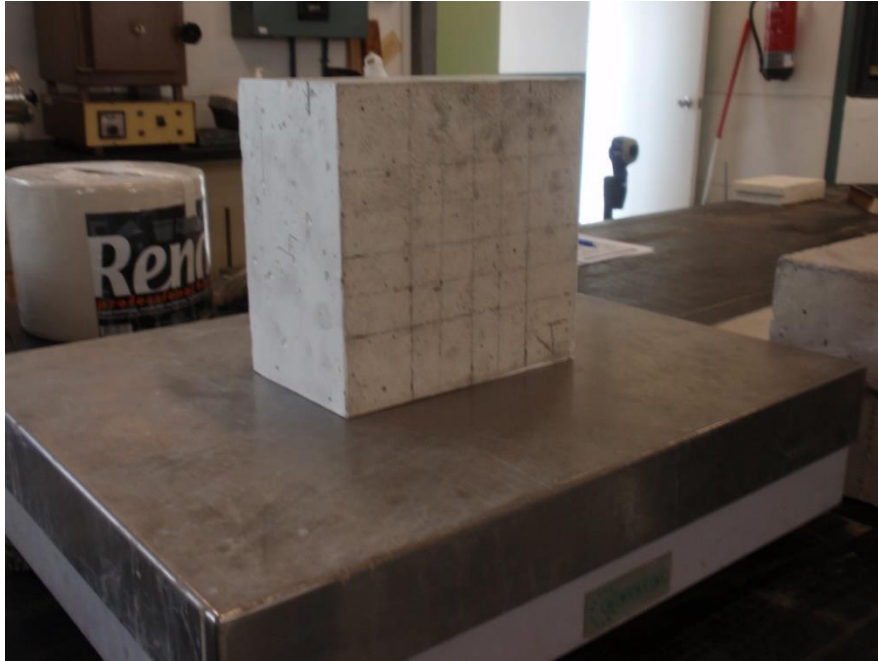
Figura 20. Medición de la masa en seco de las probetas previamente a la inmersión
