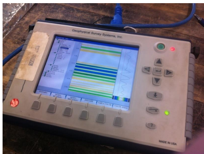
Figura 17. Equipo de GPR modelo SIR-3000
