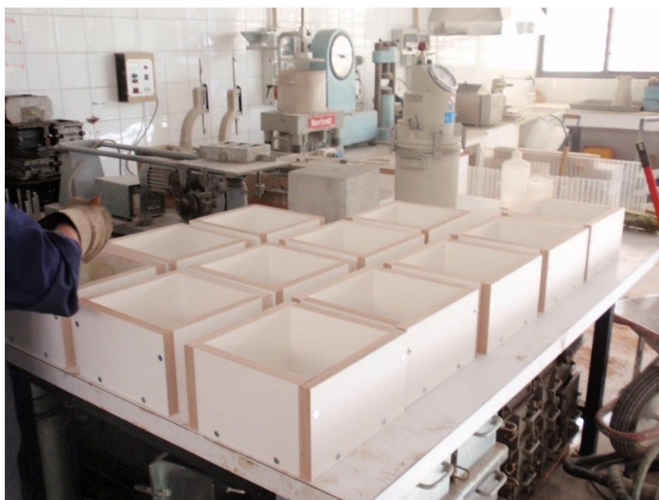
Figura 3. Moldes para la fabricación de las probetas
