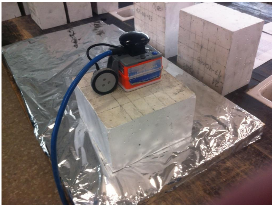
Figura 19. Colocación de la probeta sobre papel de aluminio para la medición
