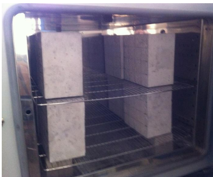
Figura 11. Tanda de secado de 8 probetas
