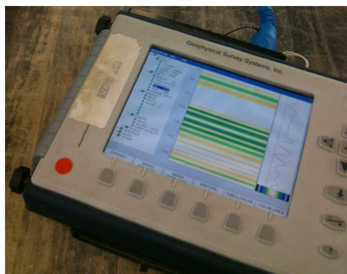
Figura 2. Representación por colores de un registro de georradar
