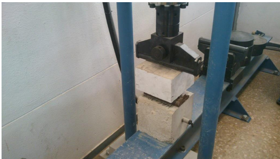
Figura 23. Rotura a flexión de las probetas
