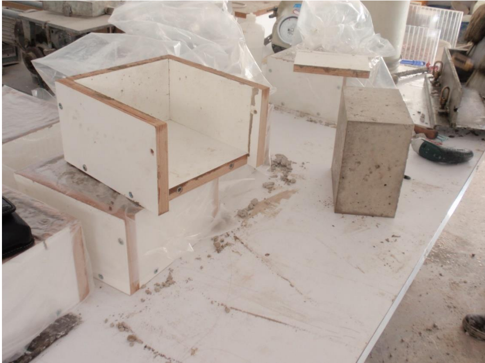
Figura 7. Desmoldado de las probetas
