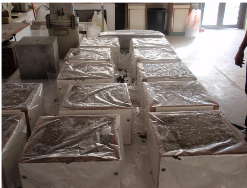
Figura 6. Cubrición de las probetas con film plástico durante 2 días
