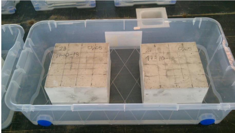
Figura 22. Inmersión de las probetas
