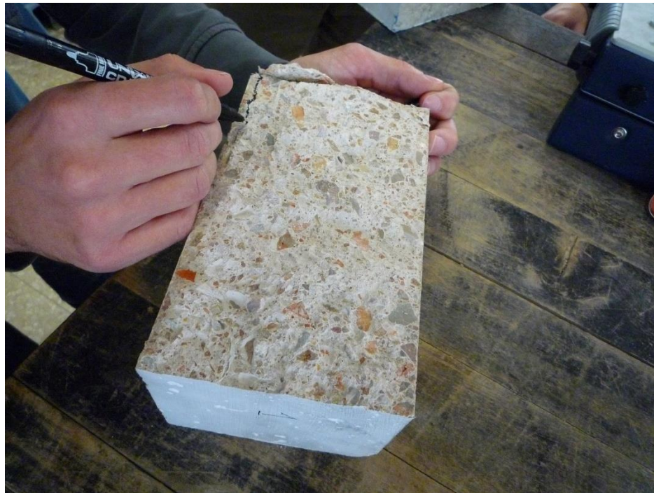
Figura 25. Delimitación del frente real de penetración de agua
