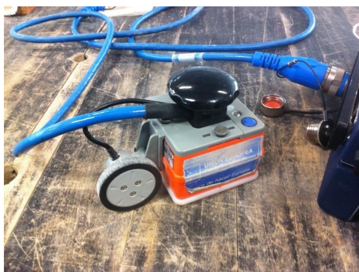
Figura 18. Antena de 2GHz montada con odómetro
