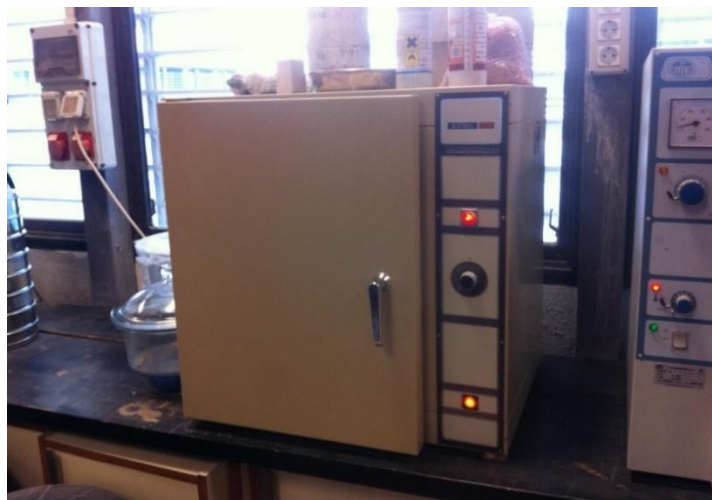
Figura 10. Horno de secado de las probetas
