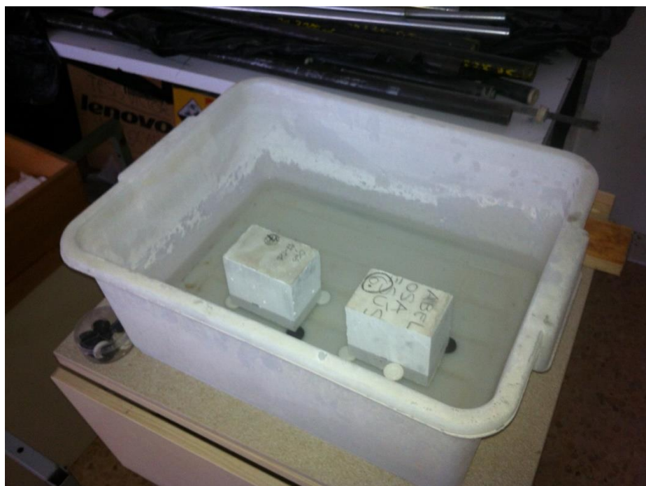
Figura 15. Inmersión de las probetas de prueba
