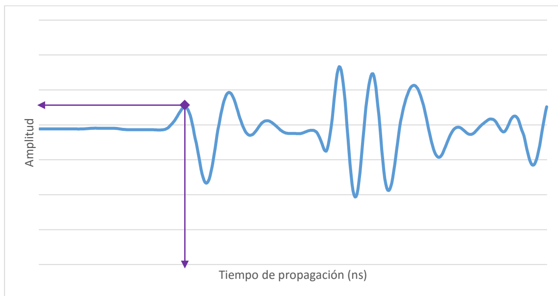
Figura 30. Traza típica registrada por el GPR
