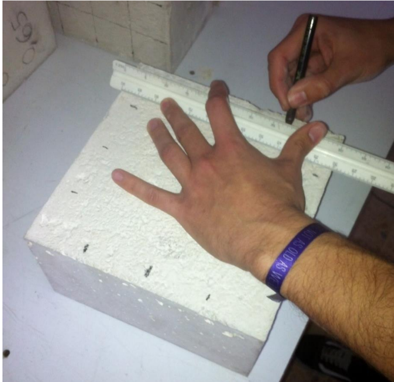
Figura 8. Dibujo de cuadrícula de referencia para mediciones con Georradar
