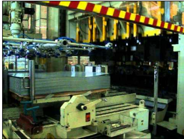
Fig. 42. Apilado de láminas de chapa planas, antes de ser conformadas.
