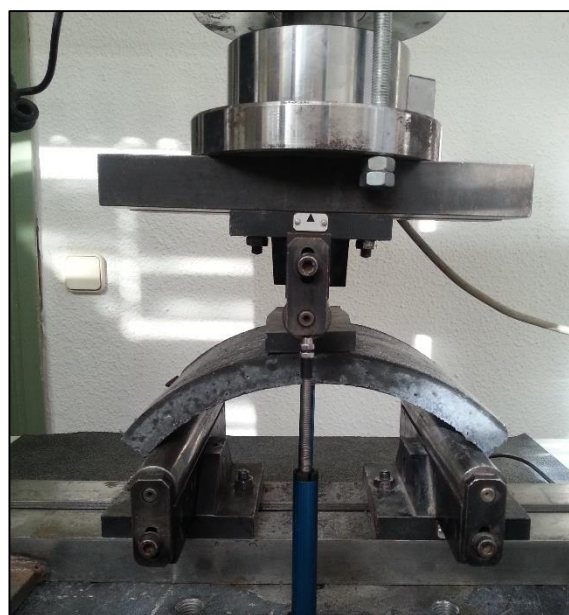
Fig. 83. Placa de serie C2, Rotura en posición convexa.
