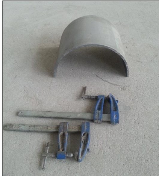
Fig. 61. Apoyo para conformado de placas de curvatura C2
