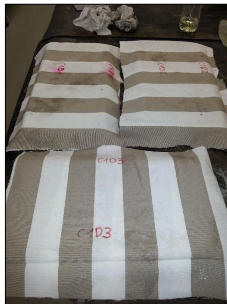
Fig. 76. Placas cubiertas antes del conformado.
