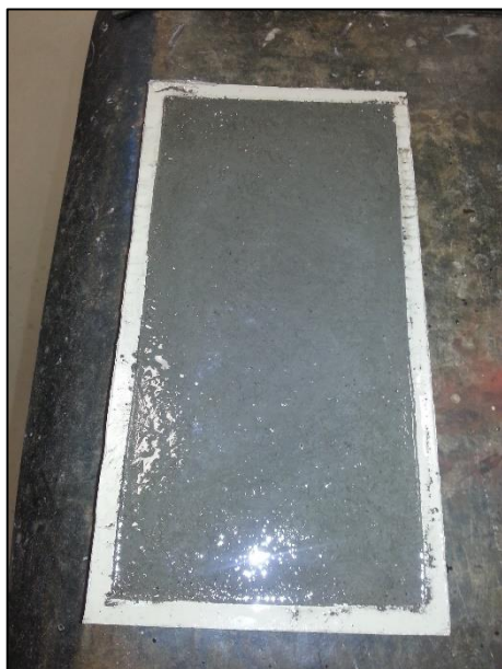
Fig. 75. Vertido de hormigón en molde flexible.
