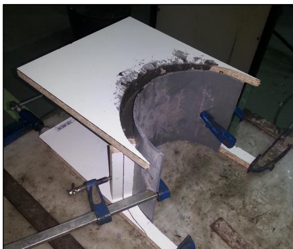
Fig. 73. Fabricación por moldeo, curvatura C2
