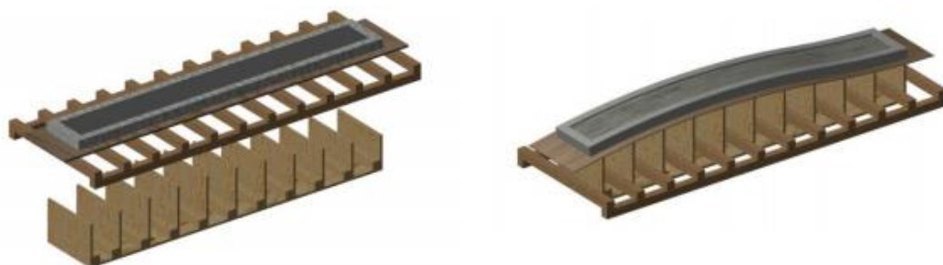
Fig. 32. Patente de molde flexible de Daan Rietbergen y Karel Vollers para elementos de una curvatura.
