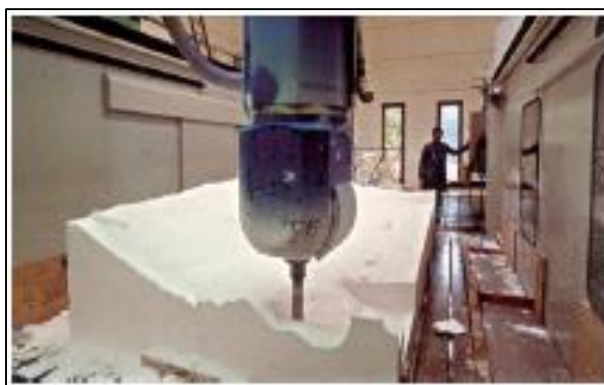
Fig. 19. Detalle de fabricación de molde con espuma CNC fresada.
