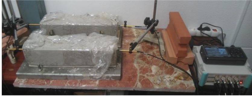
Figura 32. Ensayo de retracción autógena a edad temprana, con GL220.
