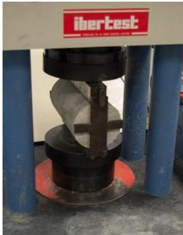
Figura 31. *Ensayo tracción indirecta.*
