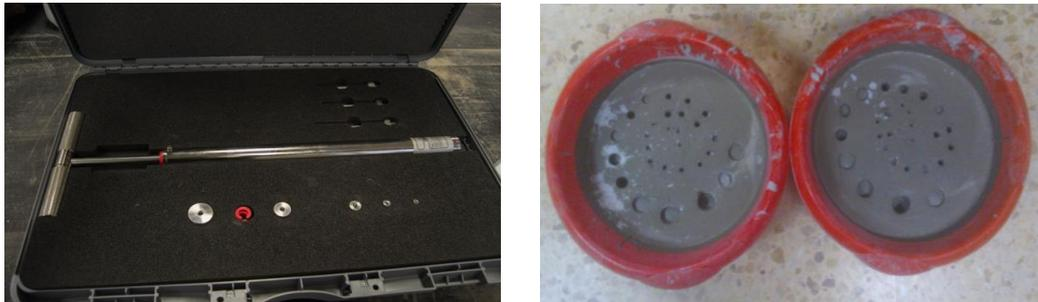
Figura 29. *Aparato de carga, agujas y varillas. Muestras de la prueba de tiempo de fraguado del hormigón.*
