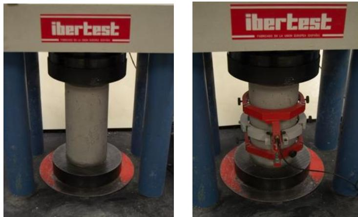
Figura 30. Ensayo a compresión y módulo de deformación.
