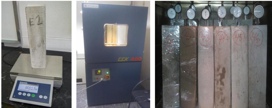
Figura 33. Pesado de probetas, cámara humedad, probetas con relojes compradores.
