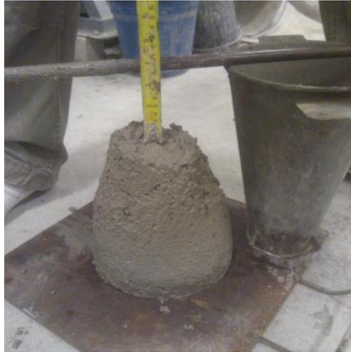
Figura 24. : Ensayo de asentamiento cono de Abrams
