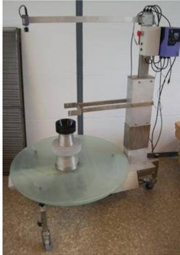
Figura 8. *Dispositivo 4C-Rheometer del CSA de la UPV*
