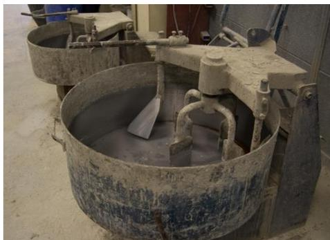
Figura 34. Amasadora planetaria de eje vertical.
