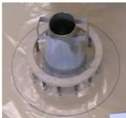
Figura 7. Ensayo de escurrimiento con anillo japonés (UNE EN 12350-12), (Tomado de Cuenca Asencio, E. 2008).
