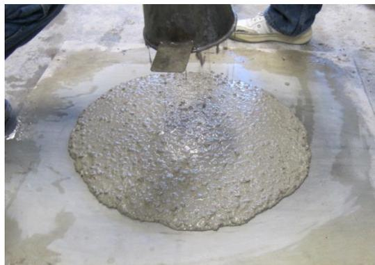
Figura 4. Ensayo de extensión de flujo o de escurrimiento (UNE EN 12350-8.)
