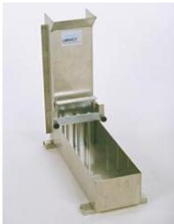
Figura 6. Esquema de la caja en L, y determinación de alturas H1-H2 (UNE EN 12350-10).
