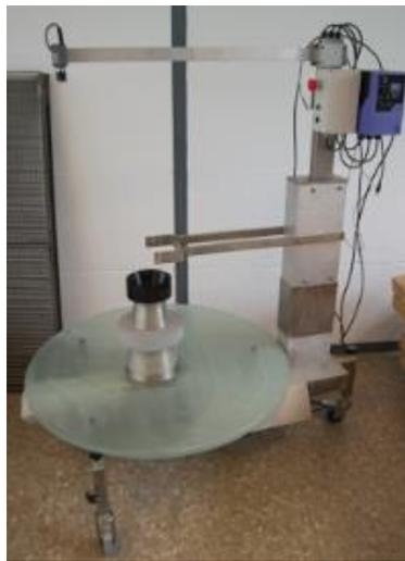
Figura 26. Reómetro.
