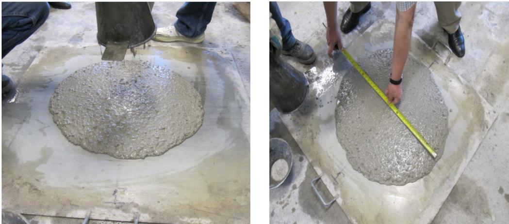
Figura 23. *Escurrecimiento hormigón autocompactante*
