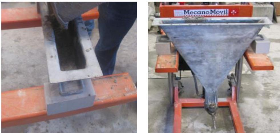
Figura 25. Ensayo del embudo en V.
