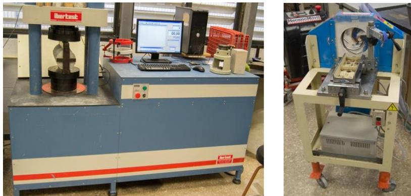
Figura 36. Prensa Ibertest modelo MEH 1500. Y máquina de refrentado Ibertest
