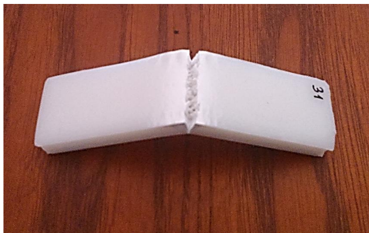
Figura 84.- Rotura de una probeta con relleno Line del 50%
