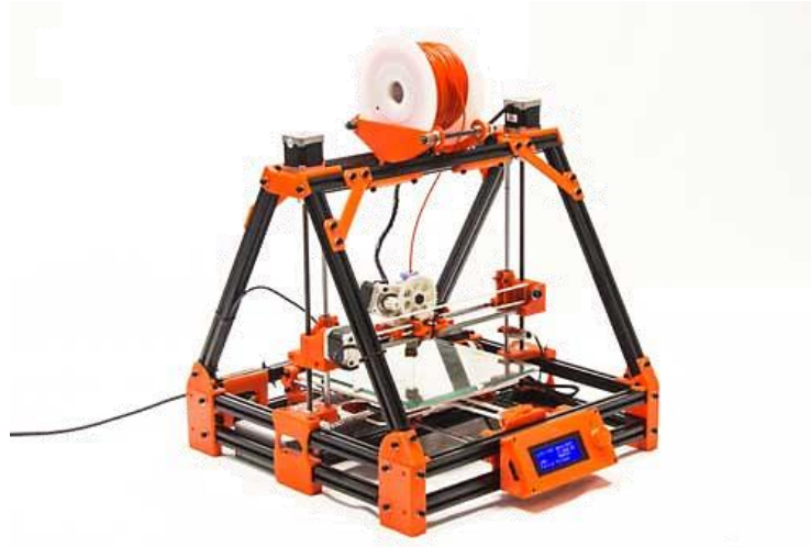
Figura 10.- Impresora con sistema de extrusión de filamento continuo 11 .
