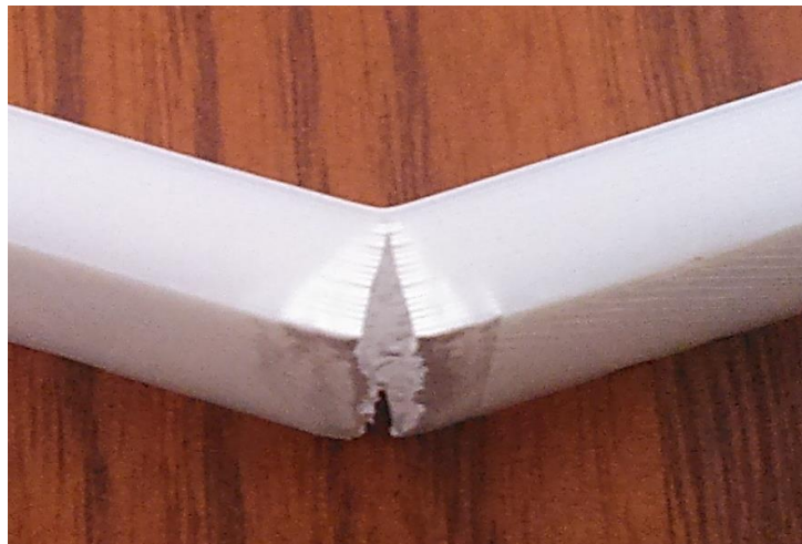
Figura 83.- Zona de rotura en una probeta con relleno Line del 20%
