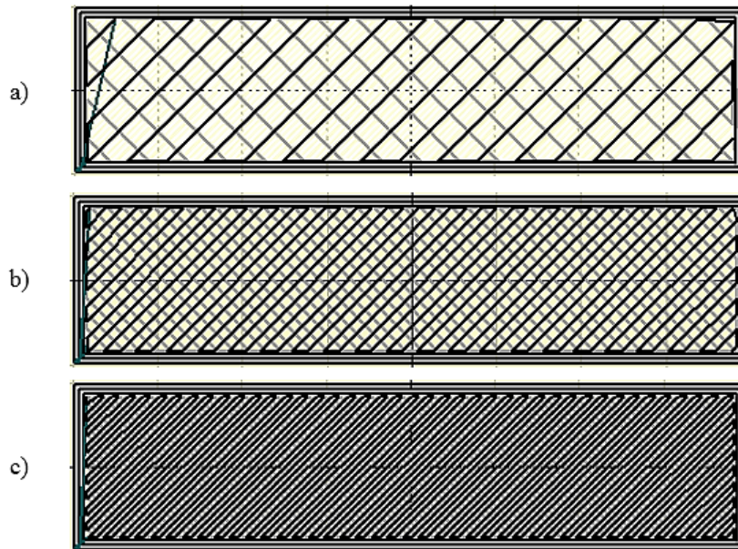
Figura 58.- Patrones de impresión a) Rectilinear, b) Honeycomb, c) Line
