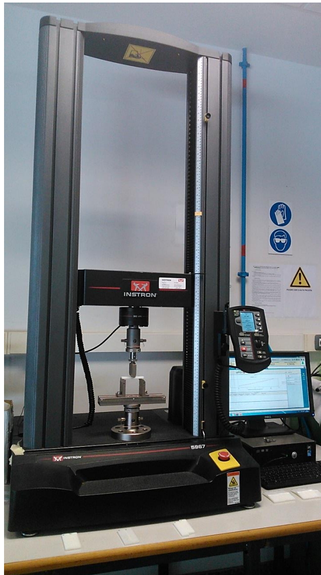
Figura 59.- Maquina Universal de Ensayos Instron 5967 utilizada en los ensayos de flexión.
