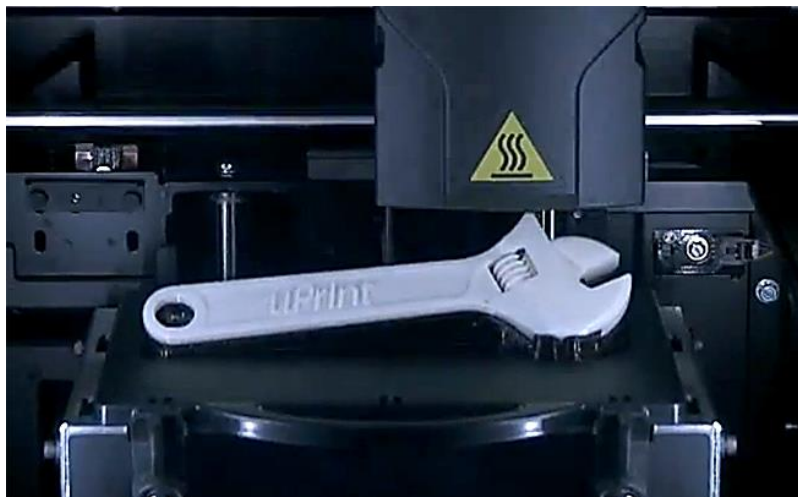
Figura 9.- Pieza con varios elementos integrados e impresos simultáneamente 10 .
