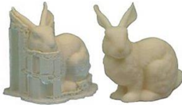
Figura 13.- Pieza impresa con soportes 16 .
