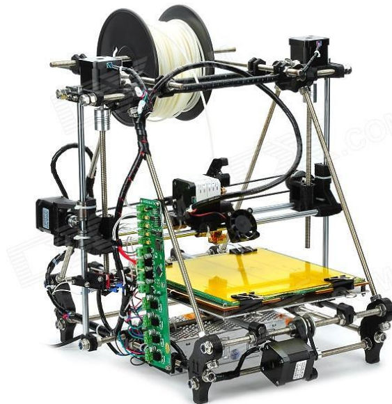
Figura 15.- Impresora Prusa Mendel parte del proyecto RepRap 18 .
